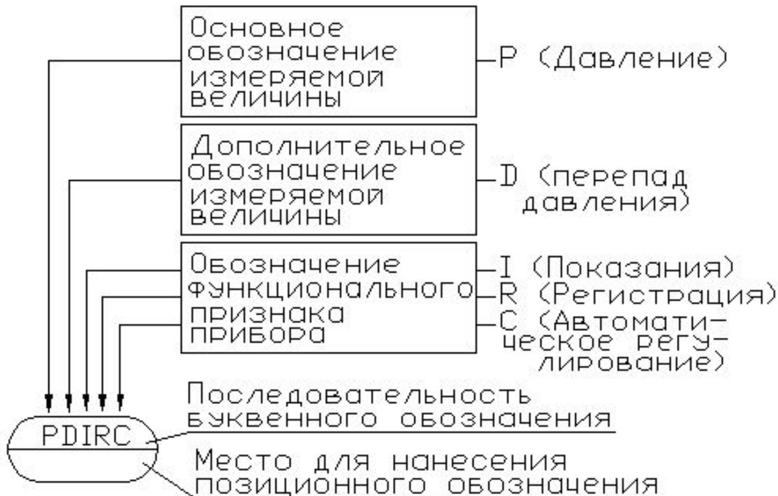
Пример построения условного графического обозначения прибора
