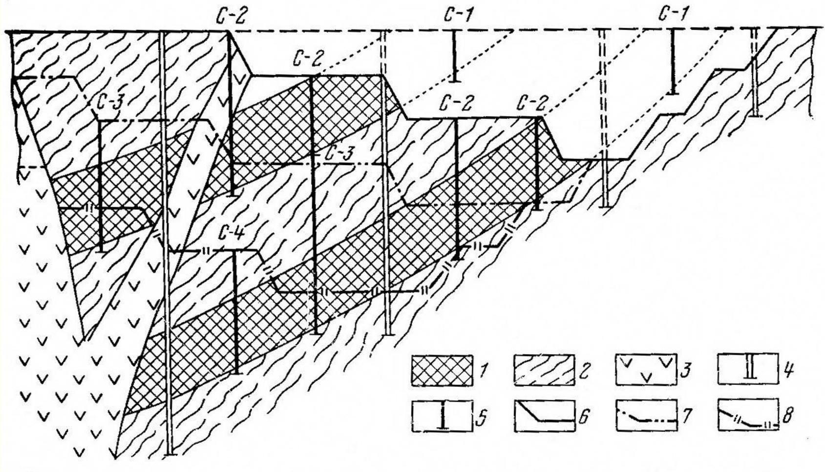
**Последовательность проходки скважин опережающей эксплуатационной разведки первого (С-1), второго (С-2), третьего (С-3) и четвертого (С-4) года разработки месторождения карьером**
