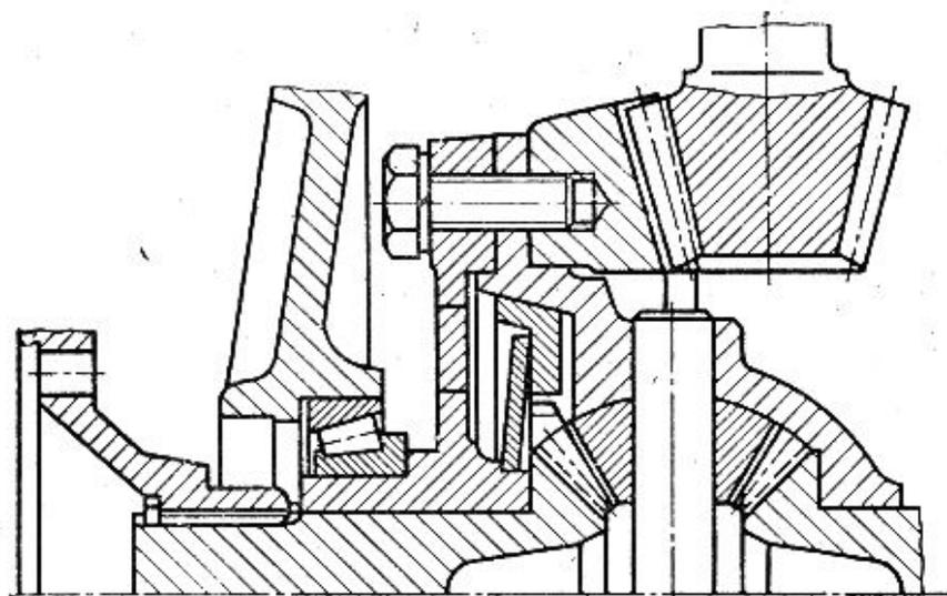
Рис. 3.48. Дифференциал повышенного трения (патент № 1167685 фирмы «Порше»)
