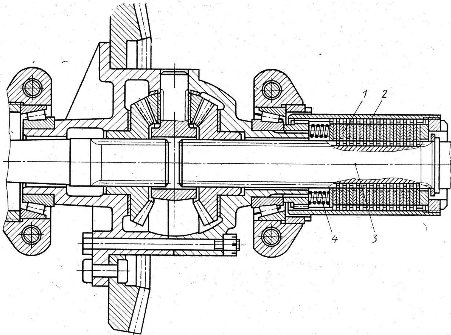
Рис. 3.44. Дифференциал с постоянным моментом трения фирмы «Тимкен»:
