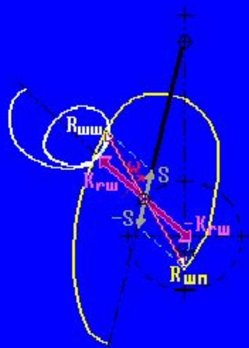
Силы, действующие на шатунную шейку коленчатого вала и шатунный подшипник
