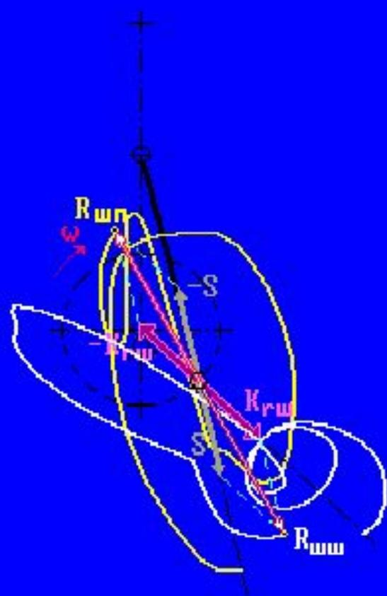
Силы, действующие на шатунную шейку коленчатого вала и шатунный подшипник
