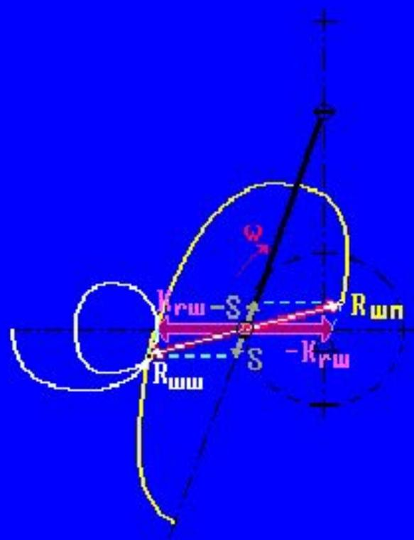
Силы, действующие на шатунную шейку коленчатого вала и шатунный подшипник
