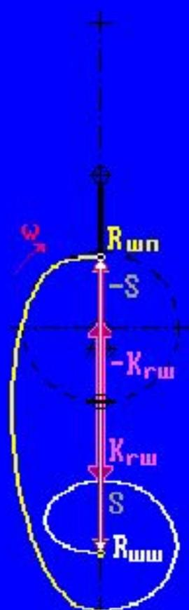
Силы, действующие на шатунную шейку коленчатого вала и шатунный подшипник
