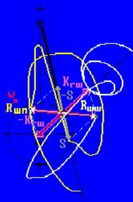
Силы, действующие на шатунную шейку коленчатого вала и шатунный подшипник
