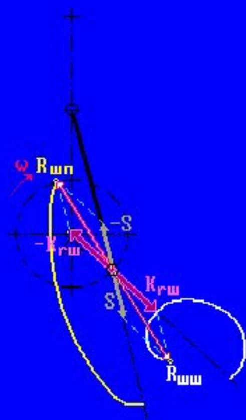
Силы, действующие на шатунную шейку коленчатого вала и шатунный подшипник
