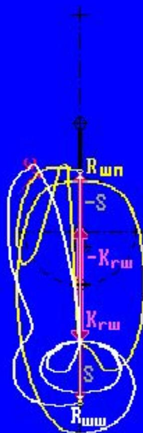
Силы, действующие на шатунную шейку коленчатого вала и шатунный подшипник
