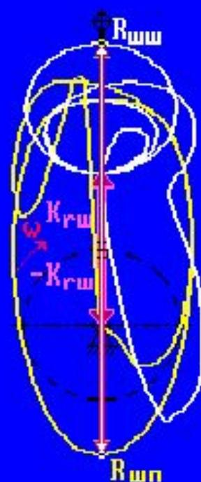
Силы, действующие на шатунную шейку коленчатого вала и шатунный подшипник
