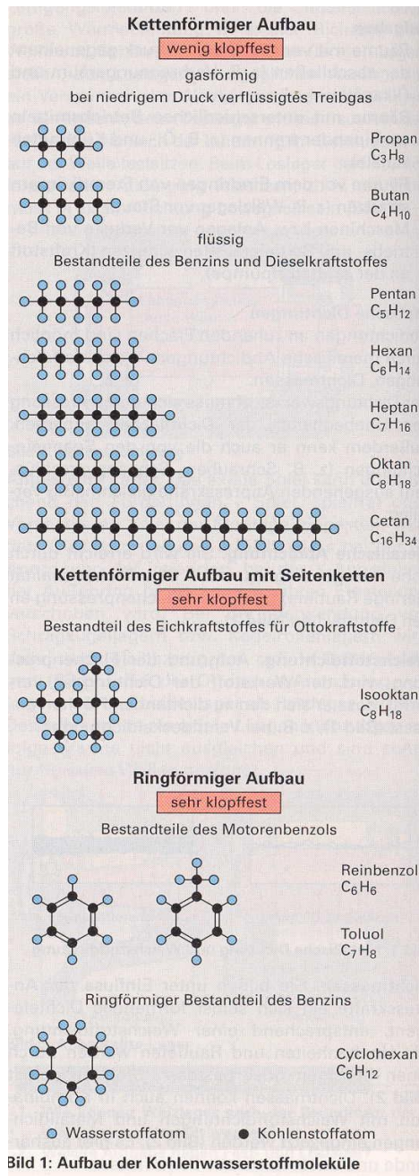
Bild 1: Aufbau der Kohlenwasserstoffmoleküle
