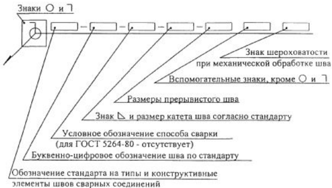
СТРУКТУРА УСЛОВНОГО ОБОЗНАЧЕНИЯ ШВА ИЛИ СВАРНОЙ ТОЧКИ
