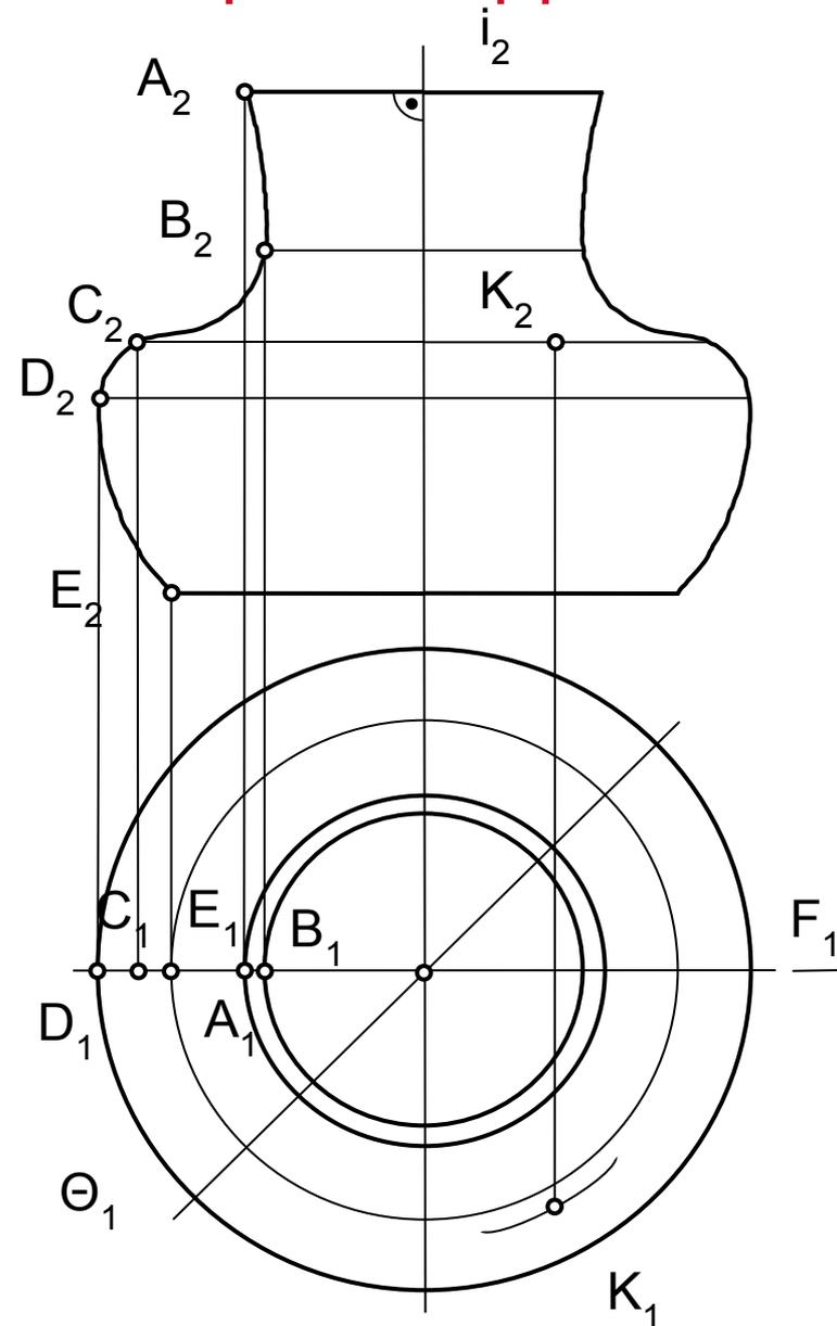
**Меридиональные плоскости** – через ось вращения. (*Главная* – параллельная плоскости проекции)
