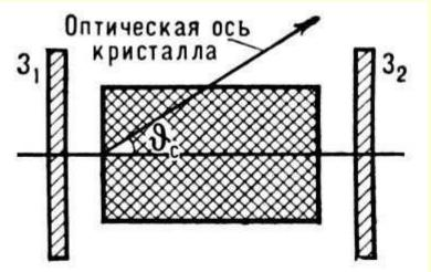
Нелинейный кристалл, помещенный в оптический резонатор;  $3_1$  и  $3_2$  — зеркала, образующие резонатор.
