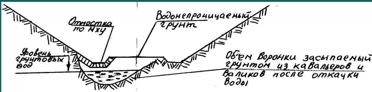
Рис.14: Заделка воронки в выемке.
