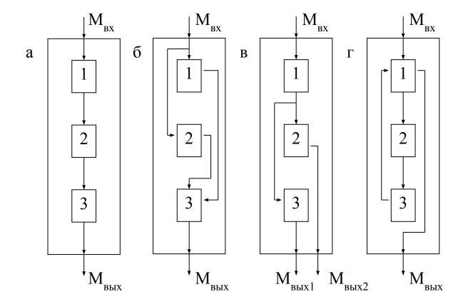
Основные типы конфигурации систем а – прямая система; б – разветвленная сходящаяся система; в – разветвленная расходящаяся система; г – циклическая система; 1,2,3 – переменные (блоки) системы; Мвх, Мвых – соответственно входные и выходные параметры
