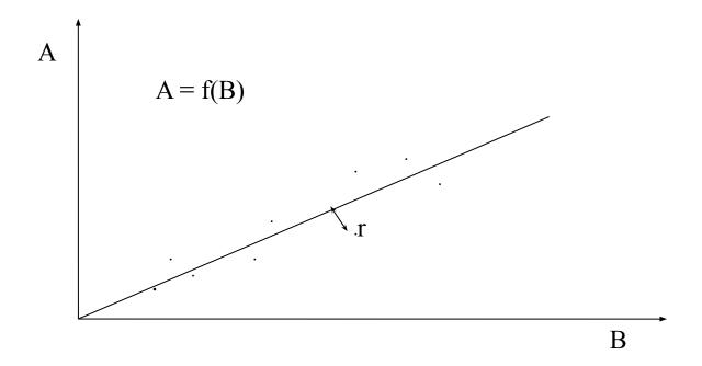
Корреляция между переменными А и В. Точки – эмпирические данные; График – линия регрессии, отражающей генерализованное направление.
