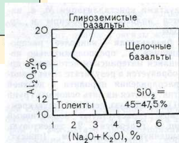
Рис. 289. Химический состав магм: толейтовой, щелочных и глиноземистых базальтов (по Х. КУНО)
