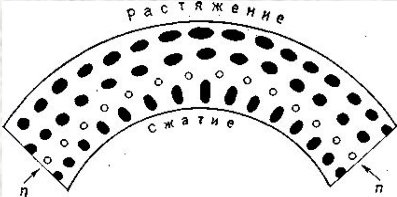
Схема напряжений в изгибаемом слое, представленная с помощью эллипсоидов, образовавшихся вследствие деформации шаров, вписанных в слой до изгиба.  $mn$  — нейтральная поверхность.
