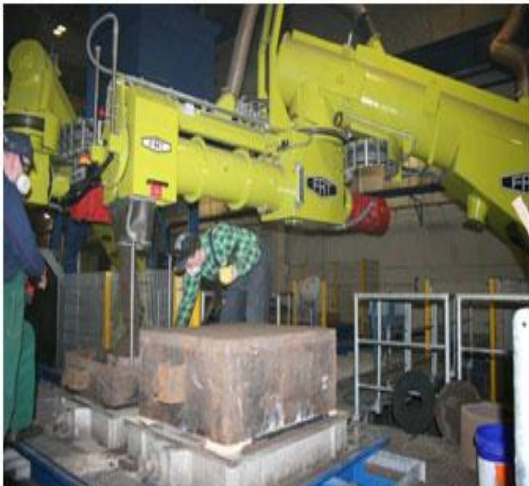
Рис. 22. Смеситель непрерывного действия фирмы FAT, Германия на заводе SHB
