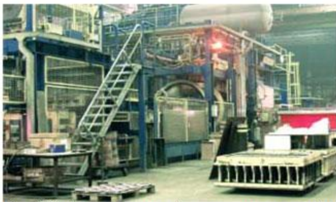
Рис. 26. Автоматическая формовочная линия фирмы HWS-Sinto, Германия по Сейатцу-процессу для стального литья на заводе SHB, Германия. Размер опок 1460x1310x400/400
