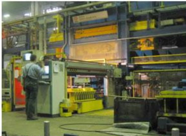
Рис. 27. Формовочная машина EFA-SD6,5 по Сейатцу-процессу фирмы HWS-Sinto, оснащенная многоплунжерной прессовой плитой
