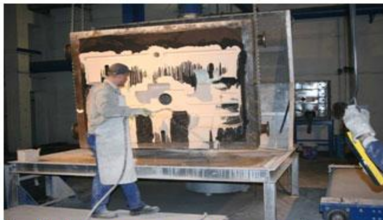
Рис.24. Станция покраски готовых полуформ
