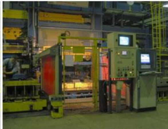
Рис. 27. Формовочная машина EFA-SD6,5 по Сейатцу-процессу фирмы HWS-Sinto, оснащенная многоплунжерной прессовой плитой
