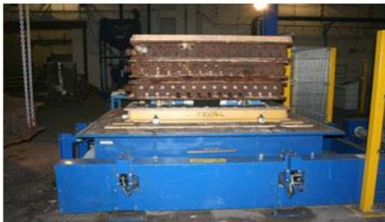
Рис. 23. Стол снятия формы с модели на линии фирмы FAT, Германия по ХТС-процессу
