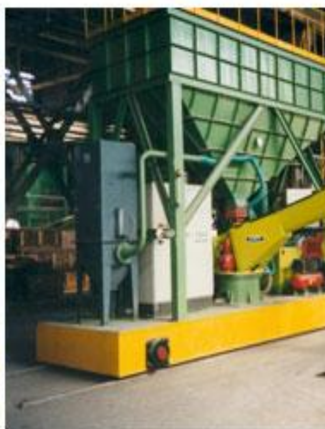
Рис.7. Передвижной и стационарный смесители (регулируемые по высоте) по DF (производительность 22–62 м 3 /ч). Область применения – изготовление болот рельефом
