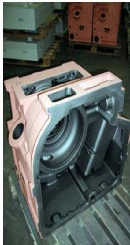
Рис. 19. Механизированная линия. Корпусная отливка, размеры 1020x945x645 мм, 410.кг. Сплав EN-GJL-200 по DIN EN 1561
