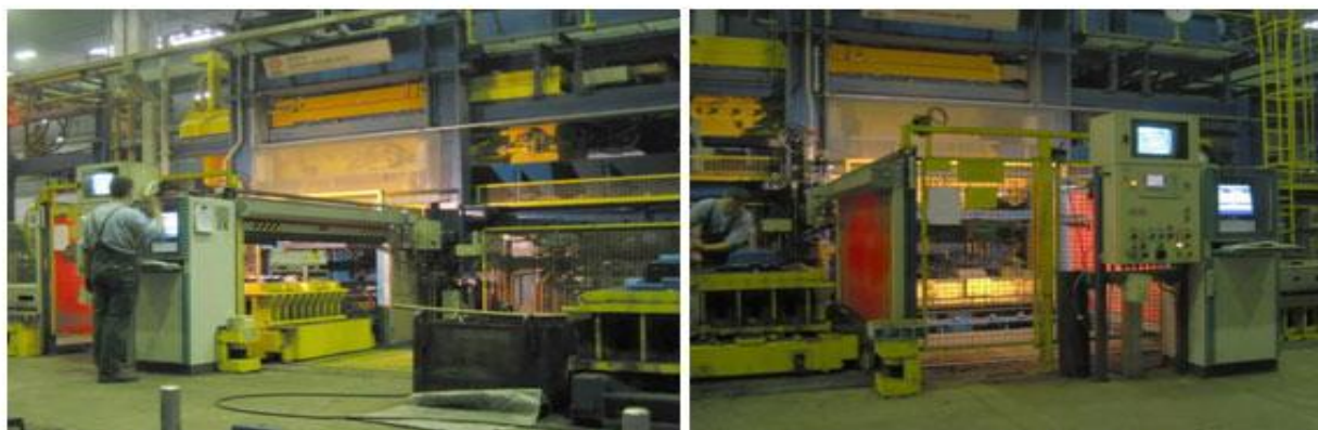
Рис. 27. Формовочная машина EFA-SD6,5 по Сейатцу-процессу фирмы HWS-Sinto, оснащенная многоплунжерной прессовой плитой
