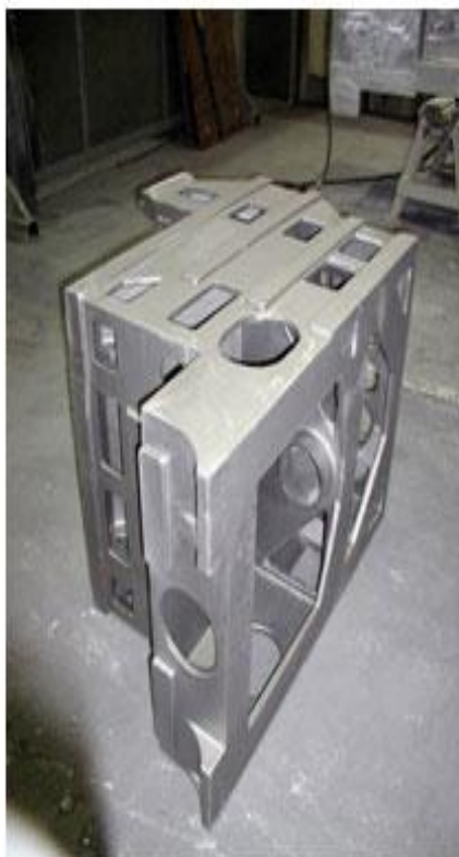
Рис. 17. Механизированная линия. Станина, размеры 1260x900x900 мм, 515.кг. Сплав EN-GJL-200 по DIN EN 1561
