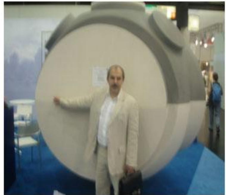
Рис.21. GIFA-07 Стержень по технологии ХТС для ветряного двигателя. Производитель - Eisengießerei Torgelow GmbH, Германия.
