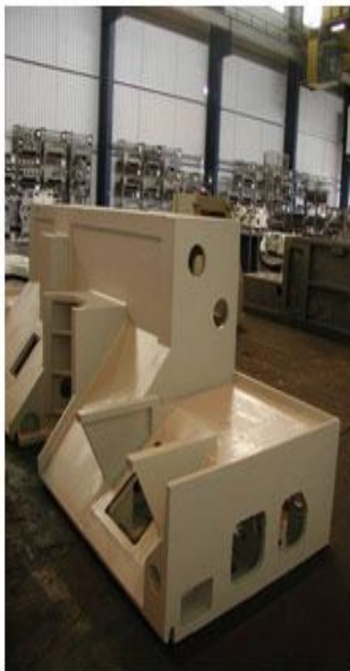
Рис.13. Станина, размеры 4810x1410x1440 мм, 6220.кг. Сплав EN-GJL-250 по DIN EN 1561
