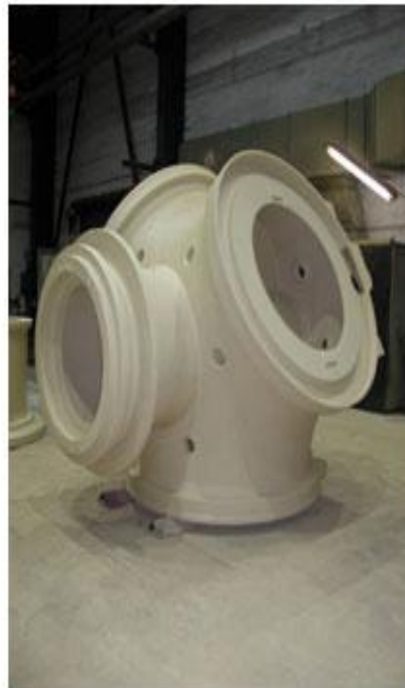
Рис.1. Отливка по ХТС-процессу, изготовленная на оборудовании фирмы FAT, Германия. Корпус несущего винта ветряка, 3800x3300x2965 мм, масса 26.415 т. Материал: EN-GJS-400-18U-LT. Завод Meuselwitz Guss
