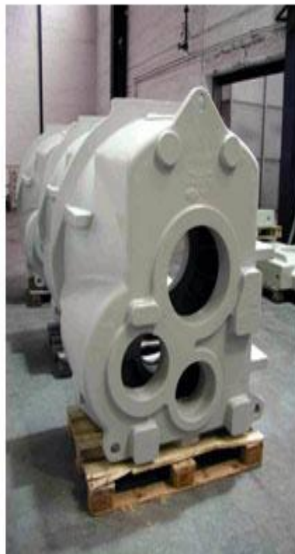
Рис. 18. Корпусная отливка, размеры 1670x1510x930 мм, 2265.кг Сплав EN-GJL-250 по DIN EN 1561
