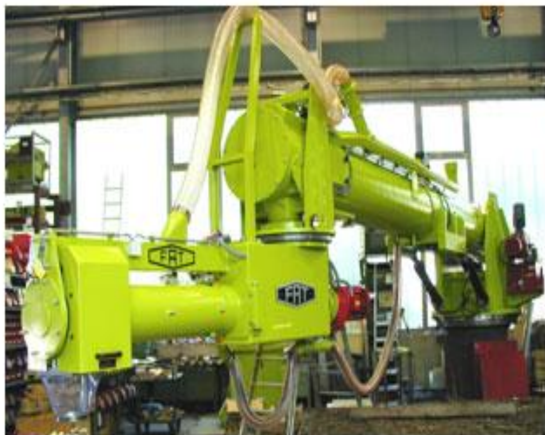
Рис.7. Передвижной и стационарный смесители (регулируемые по высоте) по DF (производительность 22–62 м 3 /ч). Область применения – изготовление болот рельефом
