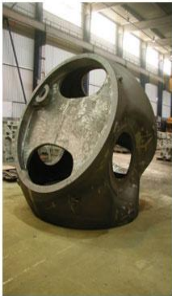
Рис.1. Отливка по ХТС-процессу, изготовленная на оборудовании фирмы FAT, Германия. Корпус несущего винта ветряка, 3800x3300x2965 мм, масса 26.415 т. Материал: EN-GJS-400-18U-LT. Завод Meuselwitz Guss
