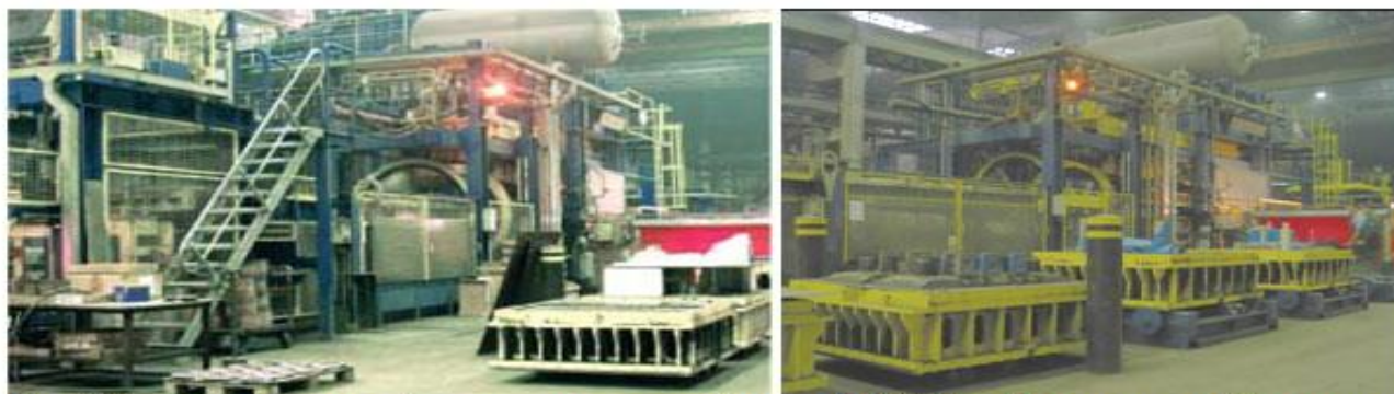
Рис. 26. Автоматическая формовочная линия фирмы HWS-Sinto, Германия по Сейатцу-процессу для стального литья на заводе SHB, Германия. Размер опок 1460x1310x400/400
