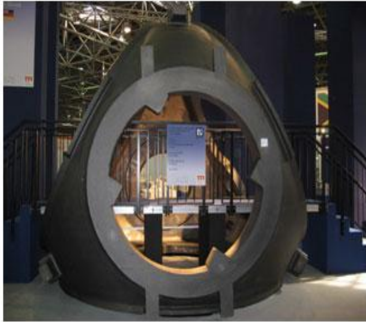
Рис.20. GIFA 07 Отливка втулка несущего винта для ветряного двигателя, 43.000кг, сплав EN-GJS-400-18U-LT. Производитель- Friedrich-Wilhelms-Hütte GmbH, Германия
