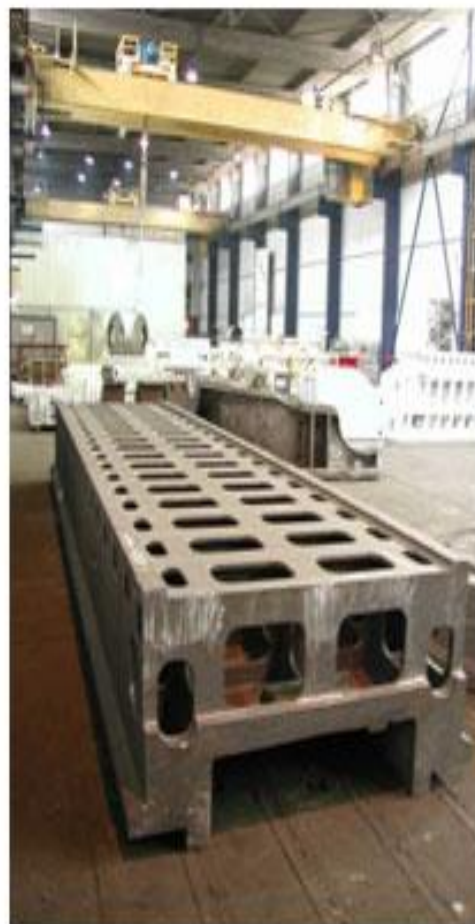
Рис.14. Станина, размеры 8600x2300x960 мм, 23280.кг. Сплав EN-GJL-250 по DIN EN 1561
