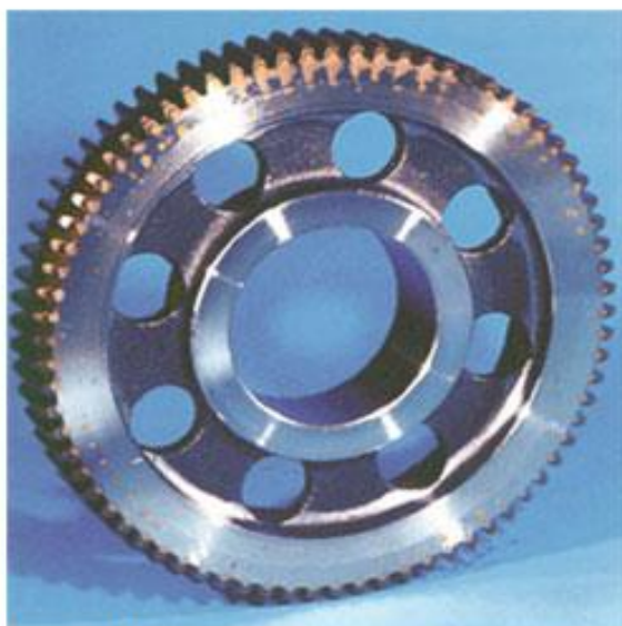
Рис. 30. Большая шестерня, материал G42CrMo4, вес 225.кг.
