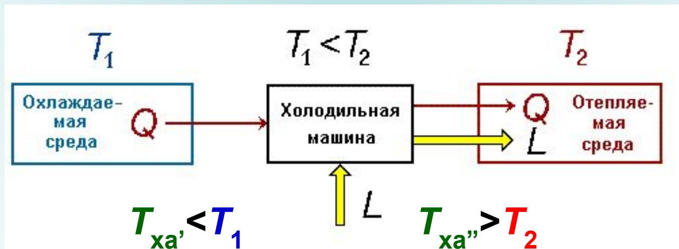
Схема отвода теплоты от окружающей среды в отапляемое помещение
