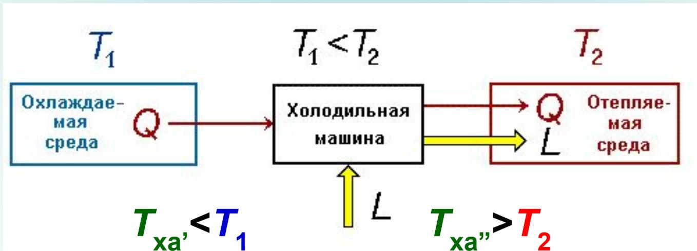
Схема отвода теплоты от окружающей среды в отепляемое помещение
