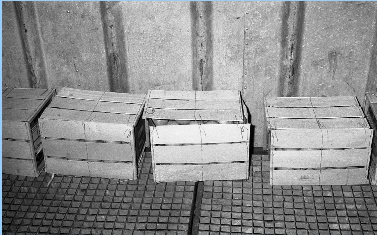
Здесь нарушено основное требование погрузки, а именно, не обеспечена плотность штабеля по длине грузового помещения.
