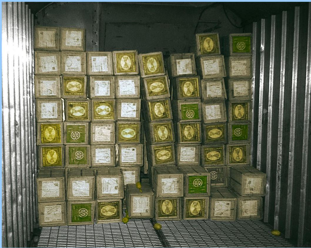
При наличии на стенах вагона (контейнера) вертикальных брусков или гофр допускается укладка груза вплотную к ним, а при отсутствии брусков и гофр грузы укладывают на расстоянии 4...5 см от продольных стен.
