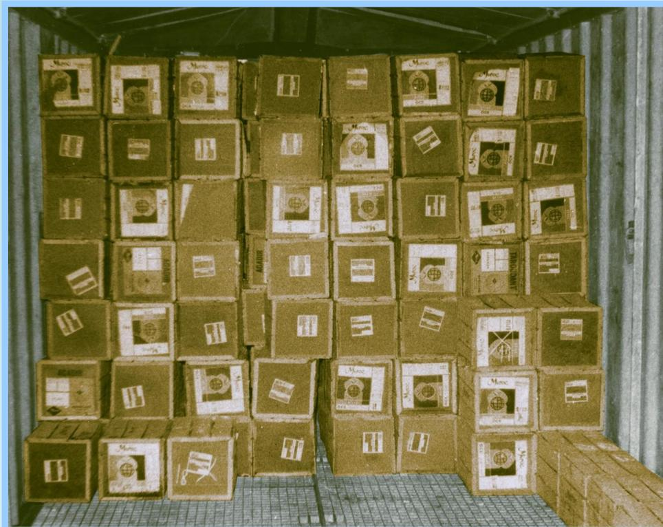
Существенным недостатком данного способа укладки ящиков является недостаточная плотность штабеля для перевозки замороженных и охлаждённых грузов в вагонах-термосах, контейнерах-термосах и рефрижераторных вагонах, следующих без охлаждения или отопления.
