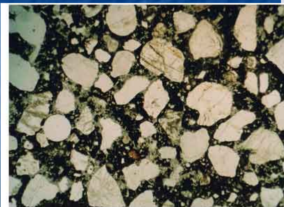
Рис. 3.5. Микрофотография шифра готового изделия (плитки): темная основная вяжущая масса – магнетитовый цемент, крупнозернистый облицовочный материал (белые зерна) представлены кварцем с примесью полевых шпатов, слюды и других минералов песка-наполнителя. Проходящий свет, кингми параллельны, увеличение 25 x
