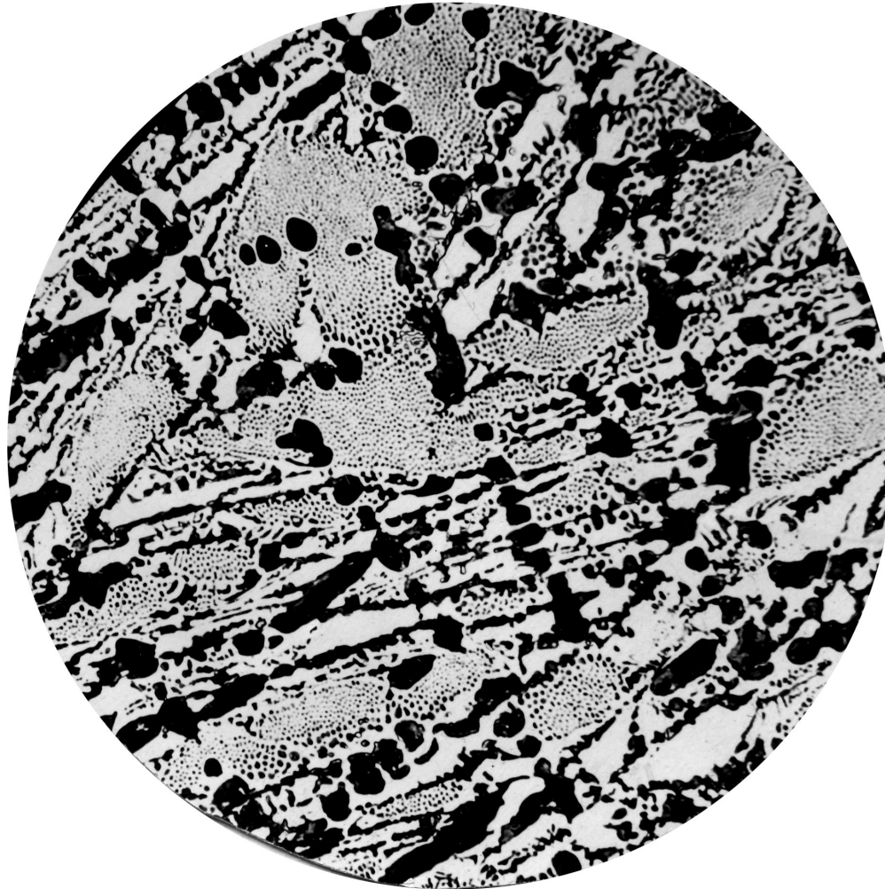
Белый доэвтектический чугун. С – 3,5 %. x200. Первичные дендриты распавшегося аустенита (перлита - тёмные) и ледебурит (пёстрый)
