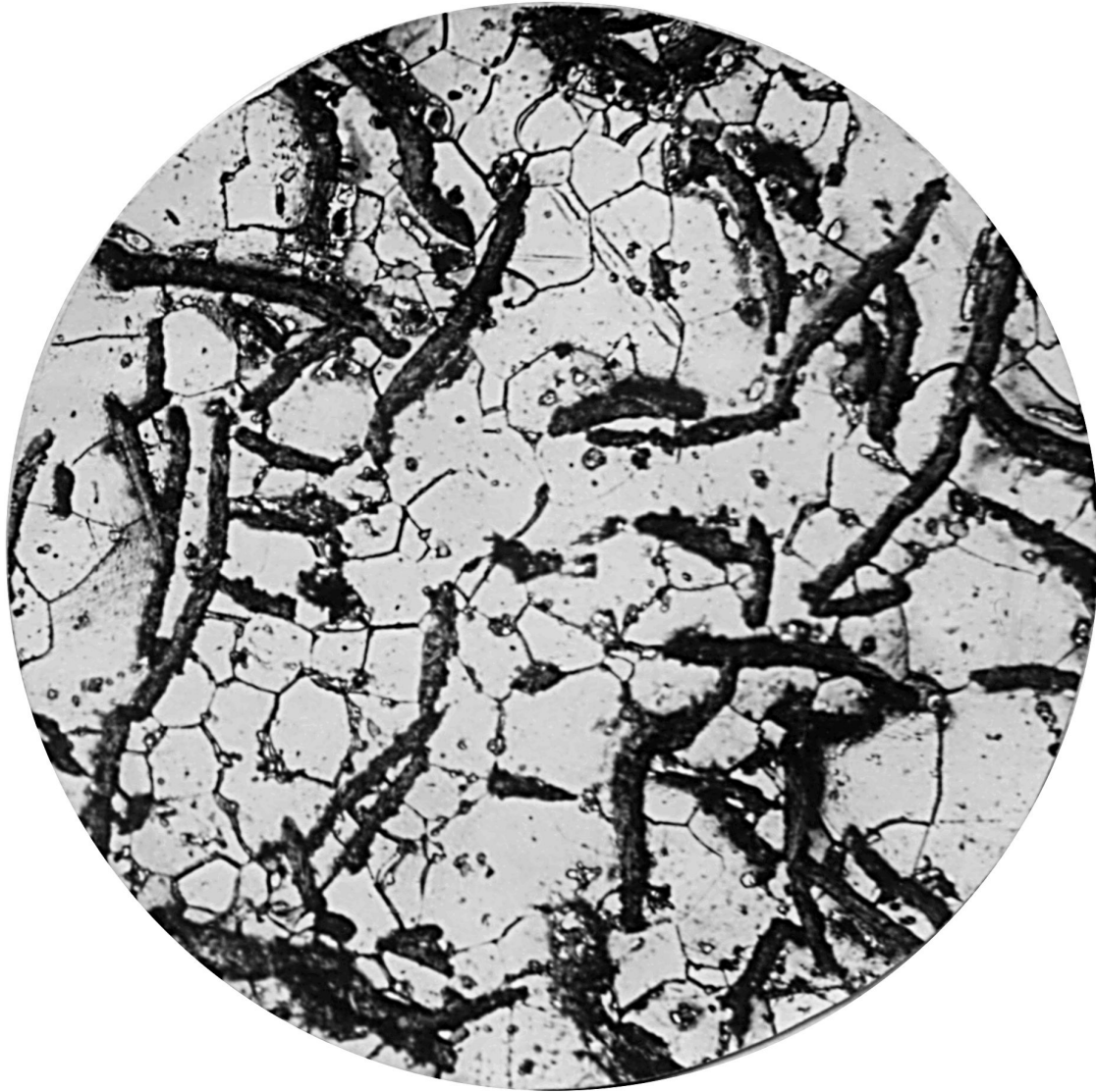
Серый литейный чугун на ферритной основе. Крупнопластинчатый графит. x200.
