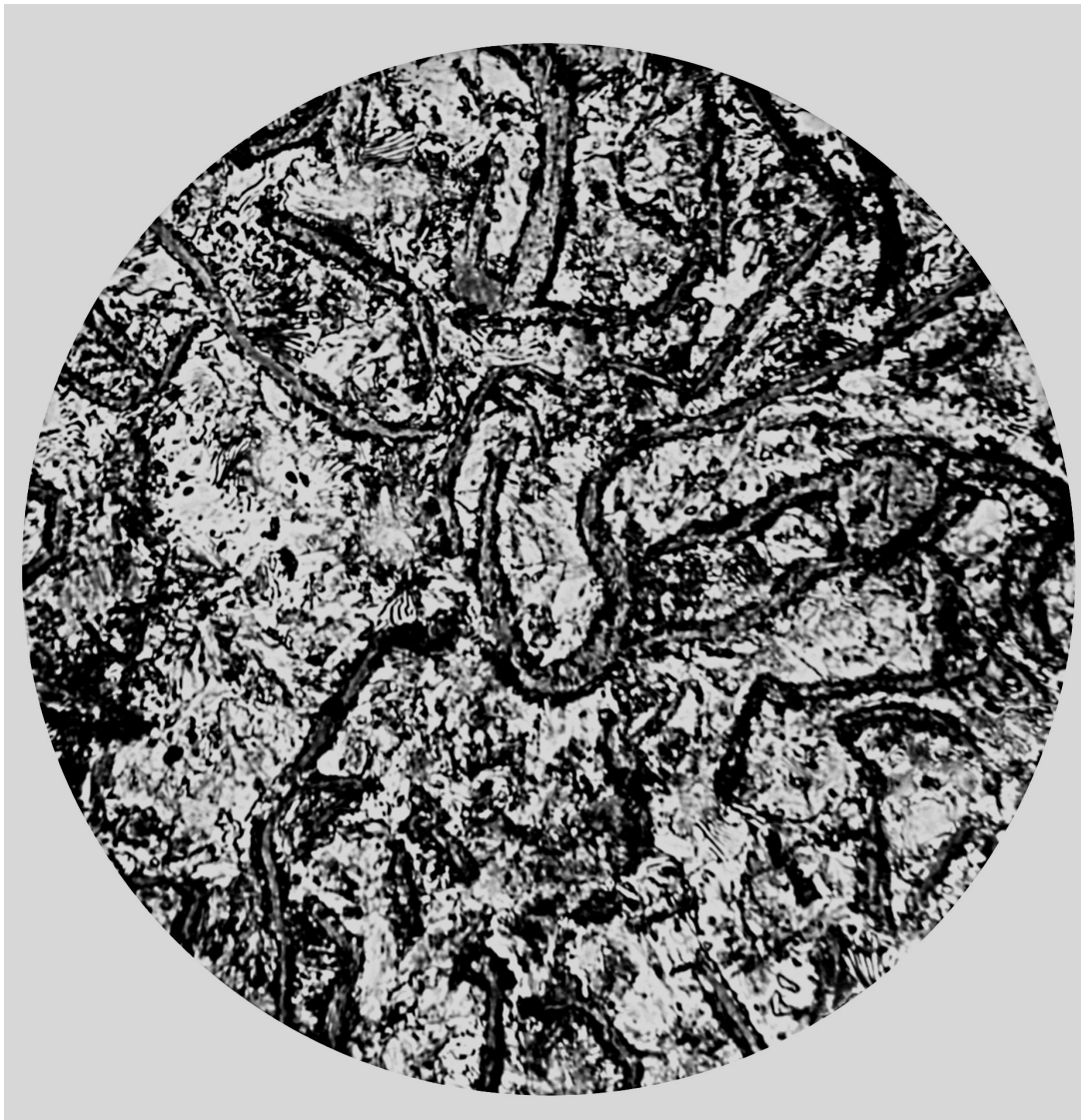
Серый литейный чугун на перлитной основе. Пластинчатый графит. x200.
