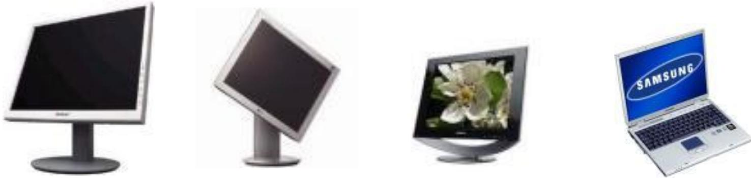
**LCD** – мониторы сделаны из вещества, которое находится в жидком состоянии, но при этом обладает некоторыми свойствами, присущими кристаллическим телам.
