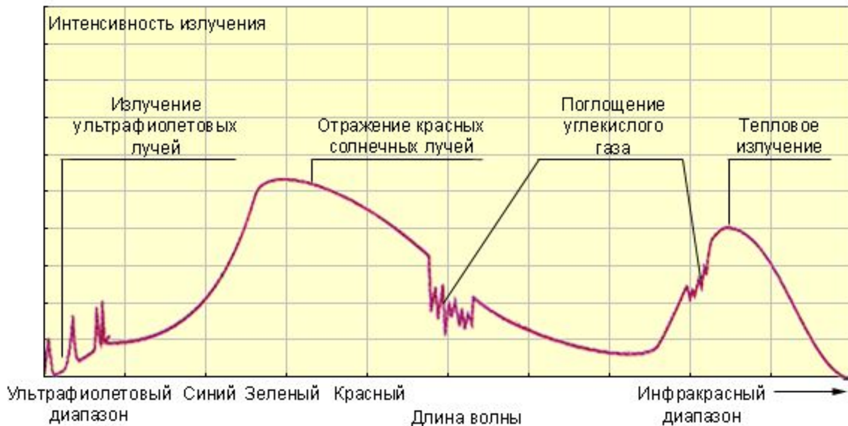
Рис. 1.2. Прохождение электромагнитного излучения сквозь атмосферу
