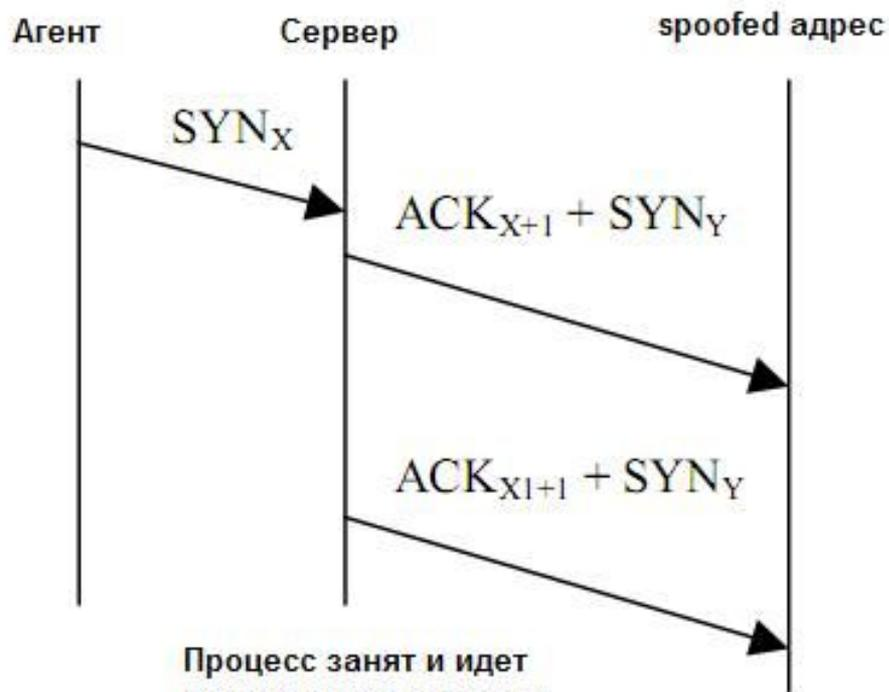
Процесс занят и идет постоянная повторная передача ACK+SYN пакета
