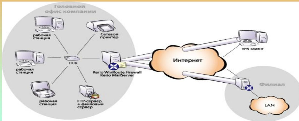
Корпоративная сеть (КС) отличается от иных тем, что правила распределения IP адресов, работы с интернет ресурсами и др. едины для всей КС. Провайдер, например, контролирует только магистральный сегмент своей сети, позволяя своим клиентам самостоятельно управлять сетью внутри КС.
