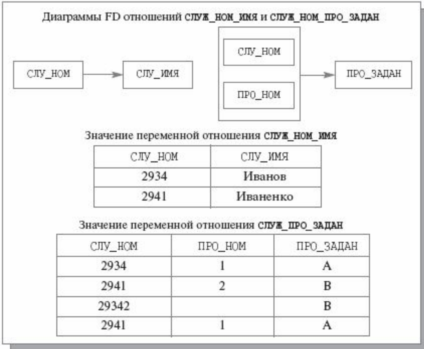
Рис. 18. Диаграммы FD и значения переменных отношений СЛУЖ_НОМ_ИМЯ и СЛУЖ_НОМ_ПРО_ЗАДАН
