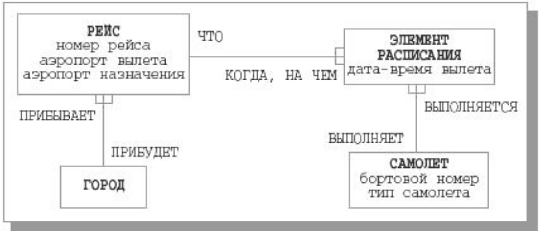
Рис. 37. Пример приведения ER-диаграммы к третьей нормальной форме
