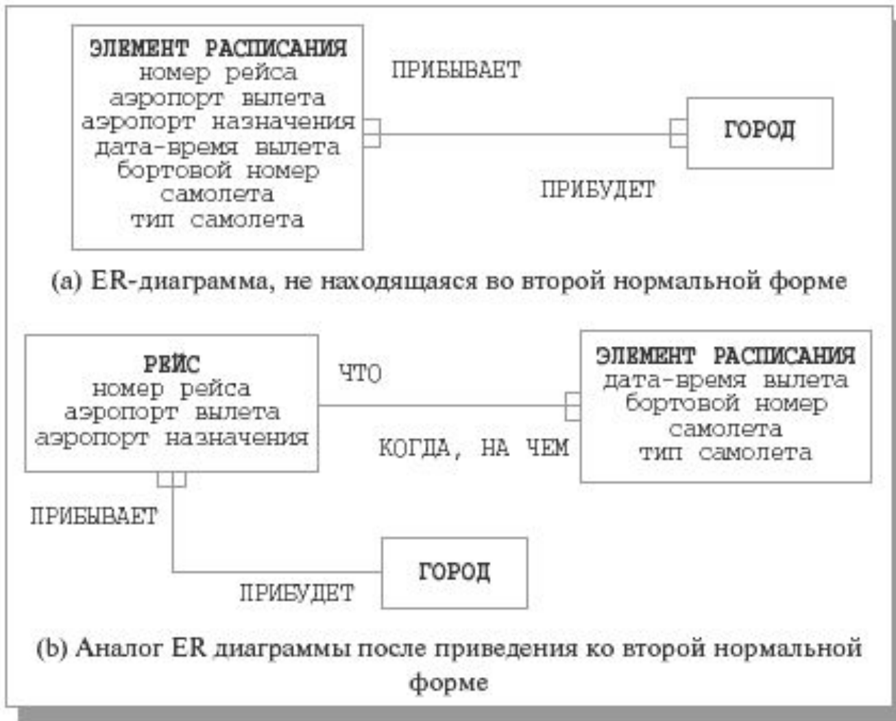
Рис. 36. Пример приведения ER-диаграммы ко второй нормальной форме
