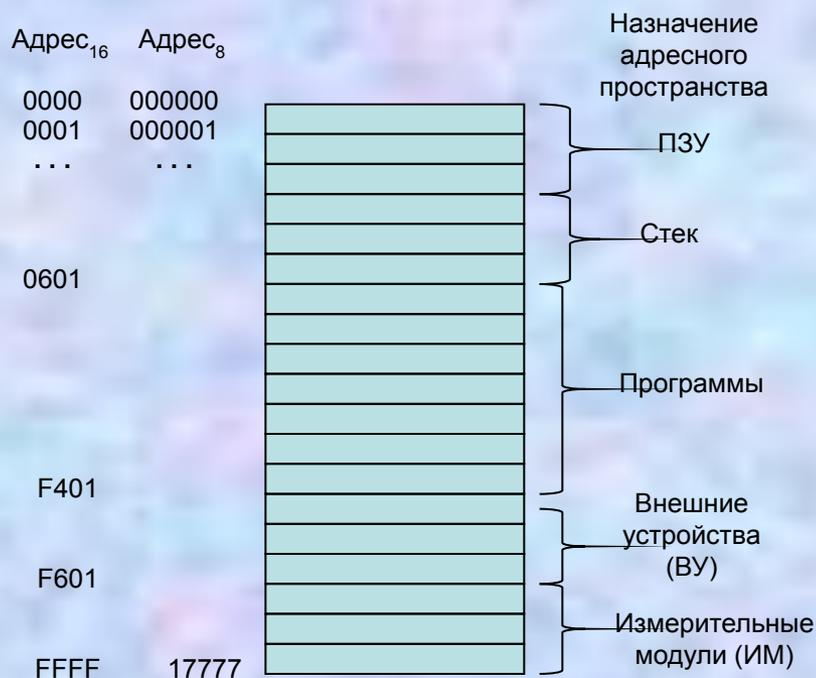
**Стек** -область памяти, предназначенная для организации прерываний как программного так и аппаратного типа. Работу со стеком обеспечивает указатель стека (SP). SP указывает на текущий адрес в стеке. Указатель адреса при записи в стек уменьшается на 2 первого слова и на 2 второго слова, т.е. указатель стека уменьшается на 4 (работает только с векторами прерываний).
