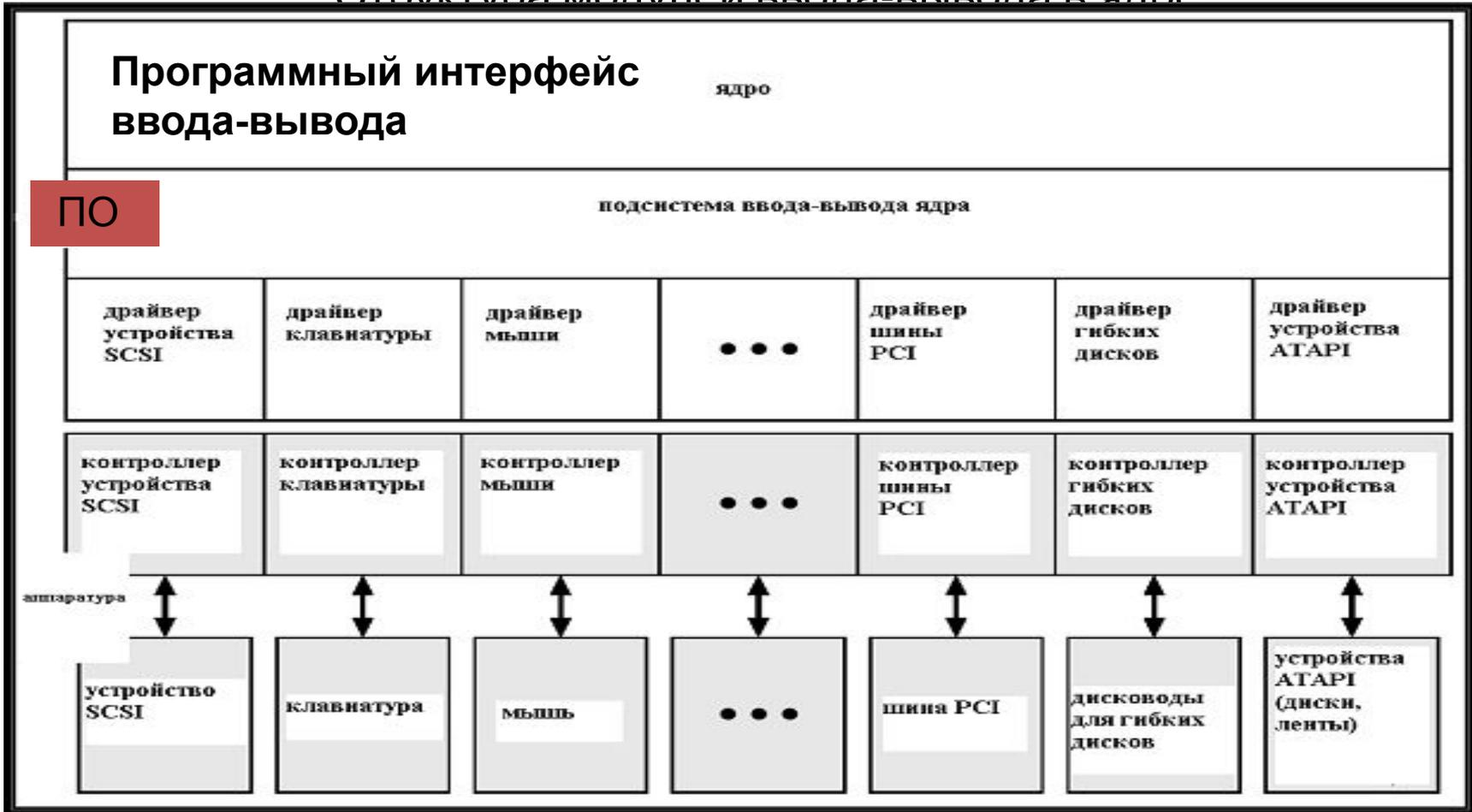
Более низкий уровень, уровень драйверов устройств, скрывает различия между контроллерами ввода-вывода конкретных устройств от ядра ОС.
