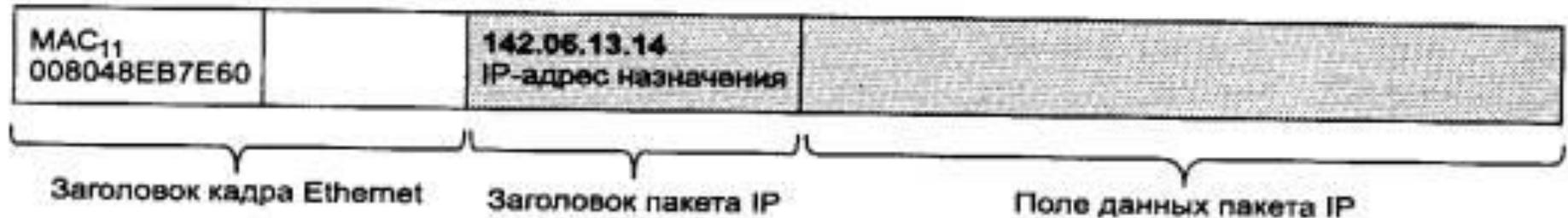
4. Порт1 маршрутизатора 1 получает кадр, протокол Ethernet извлекает из кадра IP-пакет, маршрутизатор определяет, что пакет должен быть передан на порт 2.
