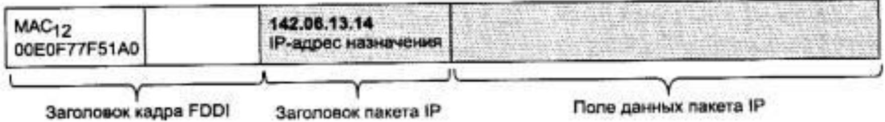
8. Аналогично действует модуль IP на маршрутизаторе 2. Для отправки следующему маршрутизатору (маршрутизатору 3) по сети Ethernet формируется кадр Ethernet.
