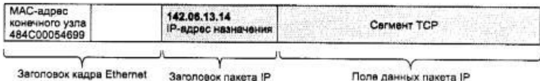
10. Сетевой адаптер s1.msk.ru захватывает кадр, обнаруживает совпадение со своим MAC адресом, и отправляет его модулю IP. В поле данных IP-пакета находится TCP-сегмент, который отправляется в очередь и попадает программному модулю FTP-сервера.
