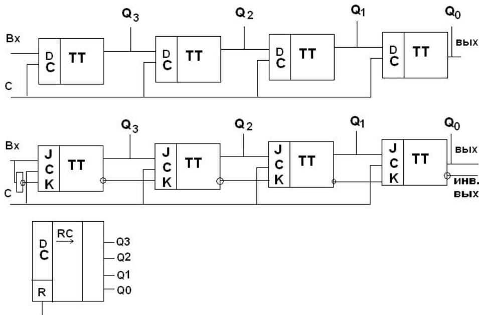
Ввод в последовательном коде ( $Q_0, Q_1 \dots$ ) через такт. Вывод в параллельном коде через выходы  $Q_0, Q_1$  или в последовательном, для этого нужно подавать синхроимпульсы и на выходе будет появляться  $a_0, a_1$ , и т.д. Можно подавать сигнал в параллельном коде, для этого используют несинхронные входы.
