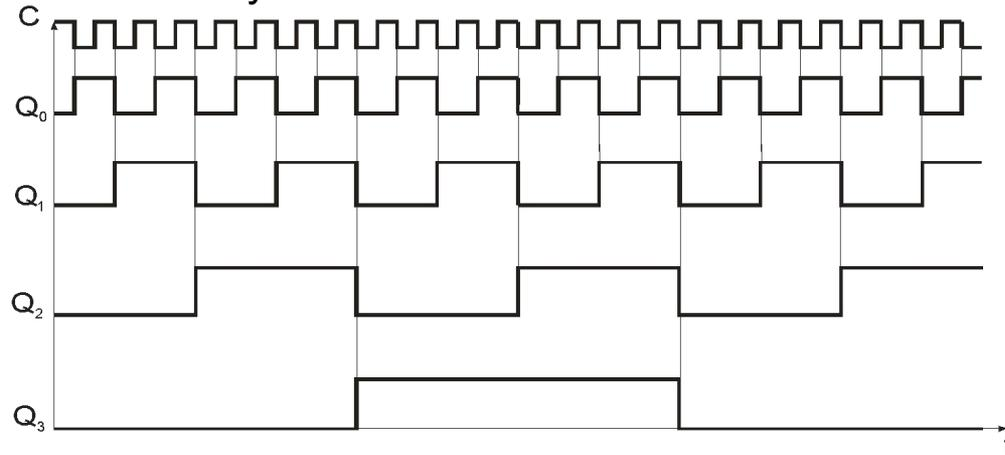
Счетчики бывают суммирующие, вычитающие, реверсивные, кольцевые, асинхронные и с дополнительной синхронизацией, а так же с параллельным переносом (для уменьшения задержки).
