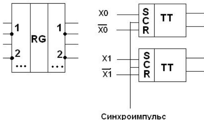
Можно на одноклаковых, тогда передача регулируется подачей на вход разрешающего импульса.
