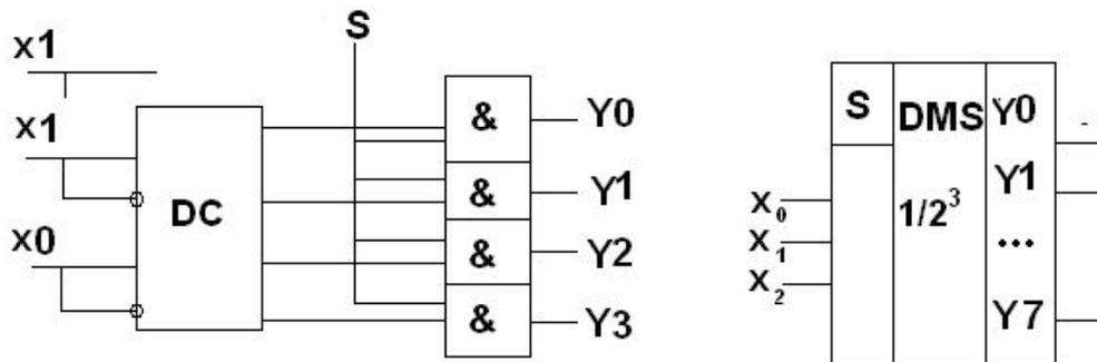
2 управляющих входа, 4 выхода:  $y_0 = Sx_1x_0$ ,  $y_1 = Sx_1x_0$ ,  $y_2 = Sx_1x_0$ ,  $y_3 = Sx_1x_0$ .
