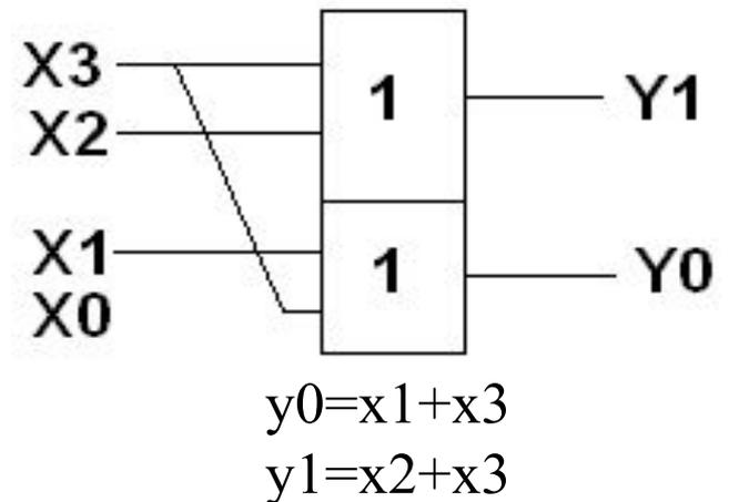
Шифраторы могут иметь противоположную логику. Например, на всех входах 1 кроме одного, на котором 0, на выходе двоичный код номера линий, где подан 0. Тогда логическая функция:  $y_0 = x_1 + x_3$ ,  $y_1 = x_2 + x_3$ .
