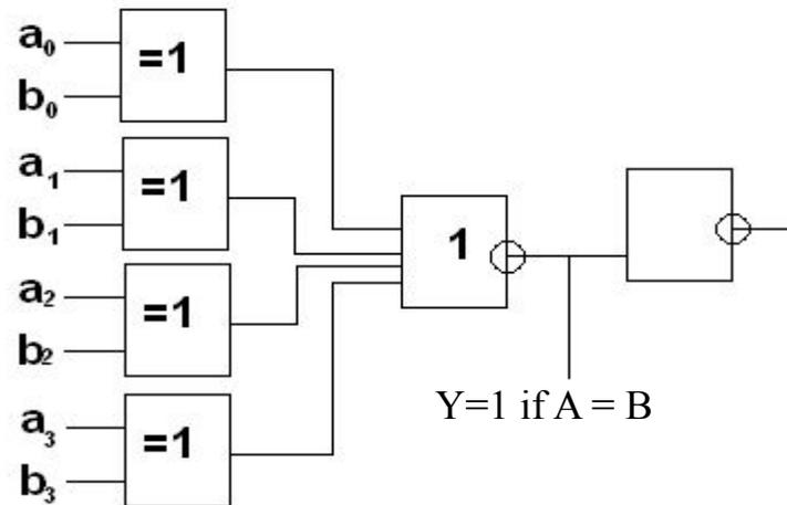
Логическая функция многоразрядного компаратора (равно/не равно)
