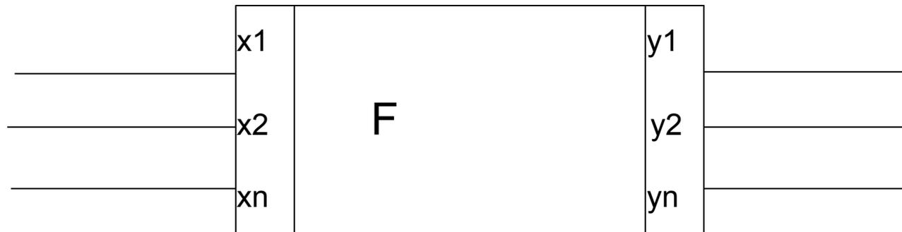
Обозначение функциональных узлов:  $x_i$  — входные параметры,  $y_j$  - выходные параметры, F — название или условное обозначение узла.
