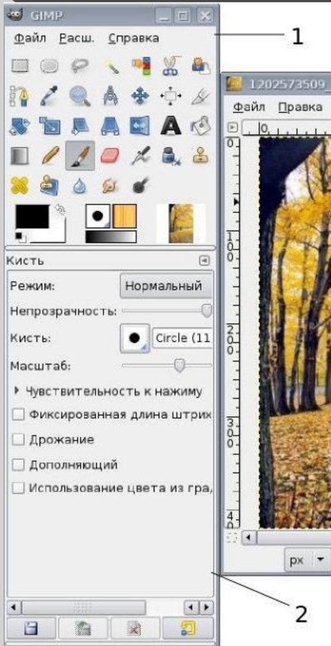
**2. Параметры инструментов:** под панелью инструментов прикреплен диалог Параметры инструментов, который отображает параметры выбранного инструмента (в данном случае это инструмент Выделение прямоугольных областей)
