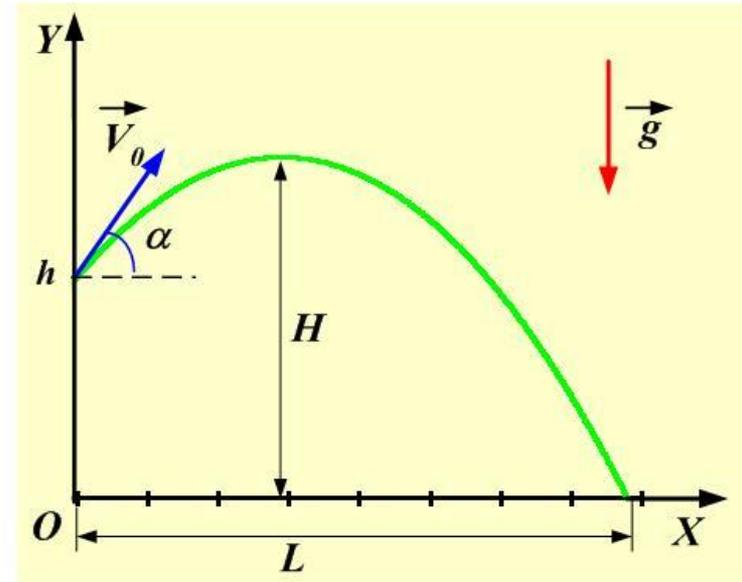
**A5.** С башни высотой  $h = 25$  м брошен камень со скоростью  $v_0 = 15$  м/с под углом  $\alpha = 30^\circ$  к горизонту. Какое время  $t$  камень будет в движении? На каком расстоянии  $L$  от основания башни он упадет на землю? С какой скоростью  $v$  он упадет на землю? Какой угол  $\phi$  составит траектория движения камня с горизонтом в точке его падения на землю?
