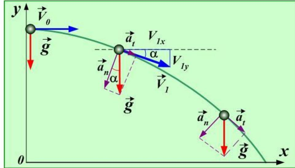
Углы между вектором скорости и осью OX и векторами полного и нормального ускорения равны, как острые углы со взаимно перпендикулярными сторонами (см.рис.).
