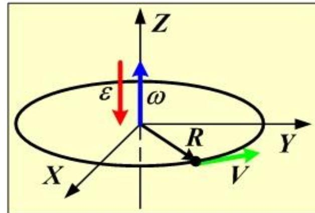
**A6.** Вентилятор вращается с частотой  $\nu = 900$  об/мин. После выключения вентилятор, вращаясь равнозамедленно, сделал до остановки  $N = 75$  об. Какое время  $t$  прошло с момента выключения вентилятора до полной его остановки?
