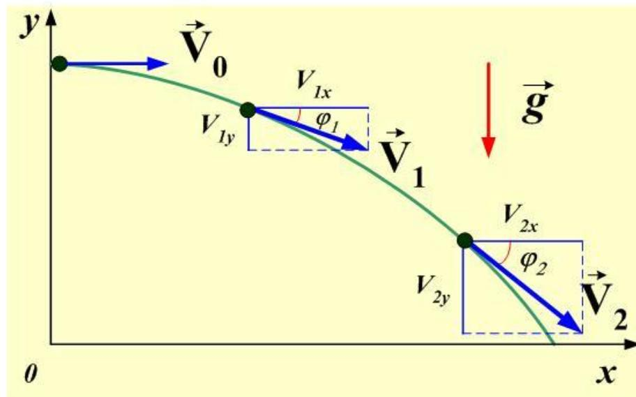
**A3.** Камень брошен горизонтально со скоростью  $v_0 = 15$  м/с. Найти нормальное  $a_n$  и тангенциальное  $a_t$  ускорения камня через время  $t = 1$  с после начала движения.
