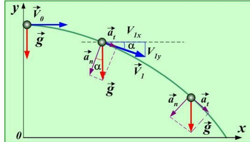
**A4.** Камень брошен горизонтально со скоростью  $v_0 = 10$  м/с. Найти радиус кривизны  $R$  траектории камня через время  $t = 3$  с после начала движения.
