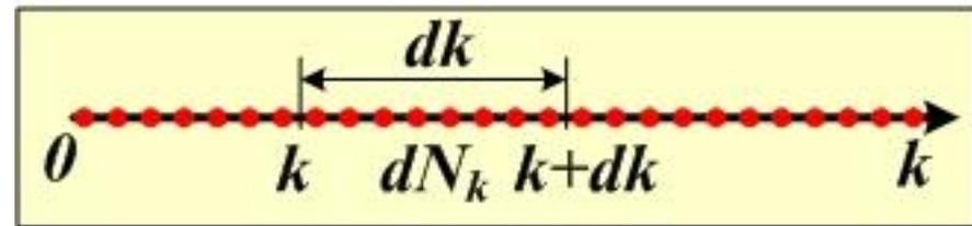
Каждому значению волнового вектора соответствует значение частоты  $\nu$ , циклической частоты  $\omega$  и длины волны  $\lambda$ . Поэтому от числа стоячих волн на интервал значений волнового вектора можно перейти к числу стоячих волн с частотой в интервале от  $\omega$  до  $\omega + d\omega$  или от  $\nu$  до  $\nu + d\nu$ .
