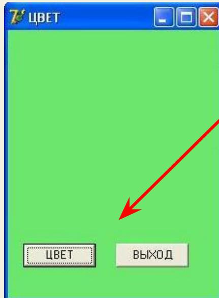
Сейчас при нажатии несколько раз кнопки «ЦВЕТ» форма красится произвольными цветами, а при нажатии кнопки «ВЫХОД» форма закрывается.
