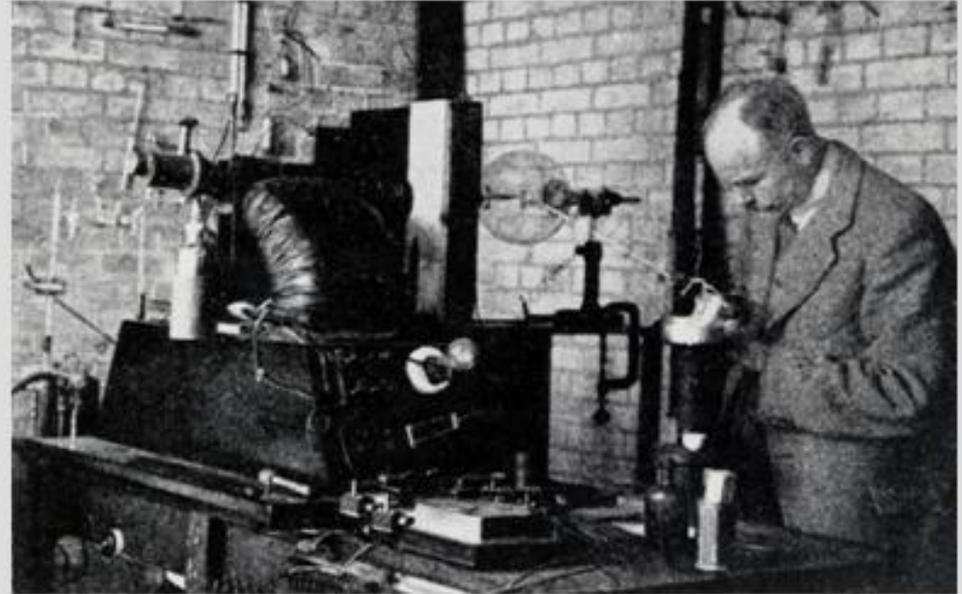
Дж. Томсон (Великобритания) изучал влияние магнитного и электрического полей на движение ионов остаточного газа, которые образуются на катоде рентгеновской трубки. Оказалось, что ионы движутся по параболическим траекториям, кривизна которых пропорциональна отношению их массы к заряду ( $m/z$ ).
