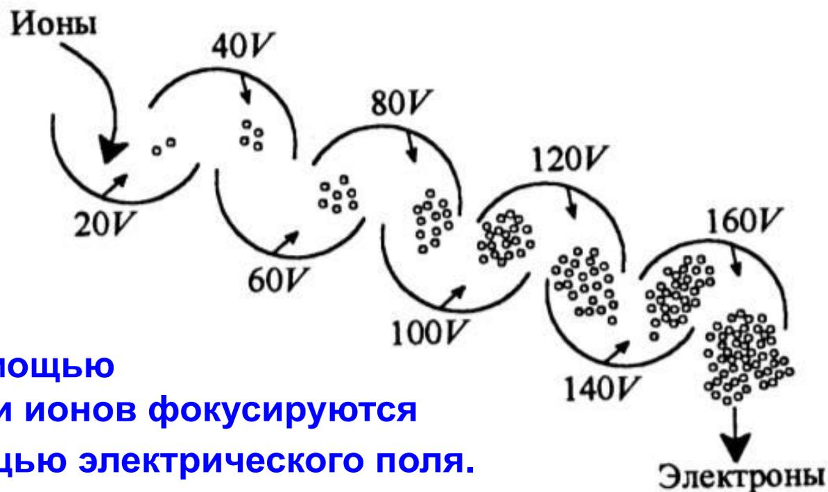
Разделенные с помощью анализатора потоки ионов фокусируются на вход ЭУ с помощью электрического поля.
