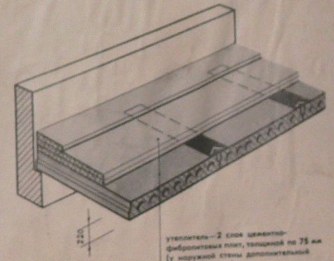
ПО МНОГОПУСТОТНОМУ НАСТИЛУ В ЧЕРДАЧНОМ ПЕРЕКРЫТИИ
