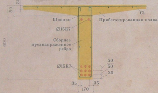
ВАРИАНТЫ АРМИРОВАНИЯ ДЛЯ ПРОЛЕТА 18м
