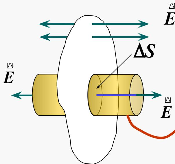
Поток вектора  $\vec{E}$  через боковую часть поверхности равен нулю.
