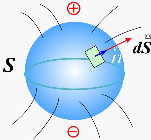
Положительными будут потоки  $d\Phi_a$  выходящие из замкнутой поверхности
