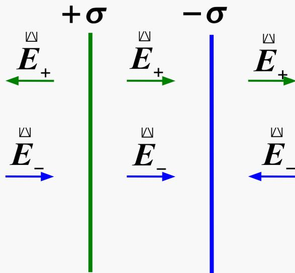
Электрическое поле определяется суперпозицией полей каждой из пластин.
