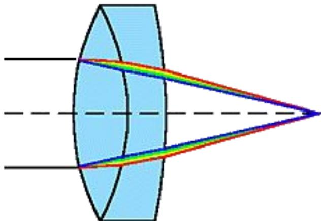
У положительной линзы хроматизм положения отрицательный, а у отрицательной линзы положительный. Следовательно, для исправления хроматизма положения можно соединить, одну положительную и отрицательную линзы из разных марок стекла.
