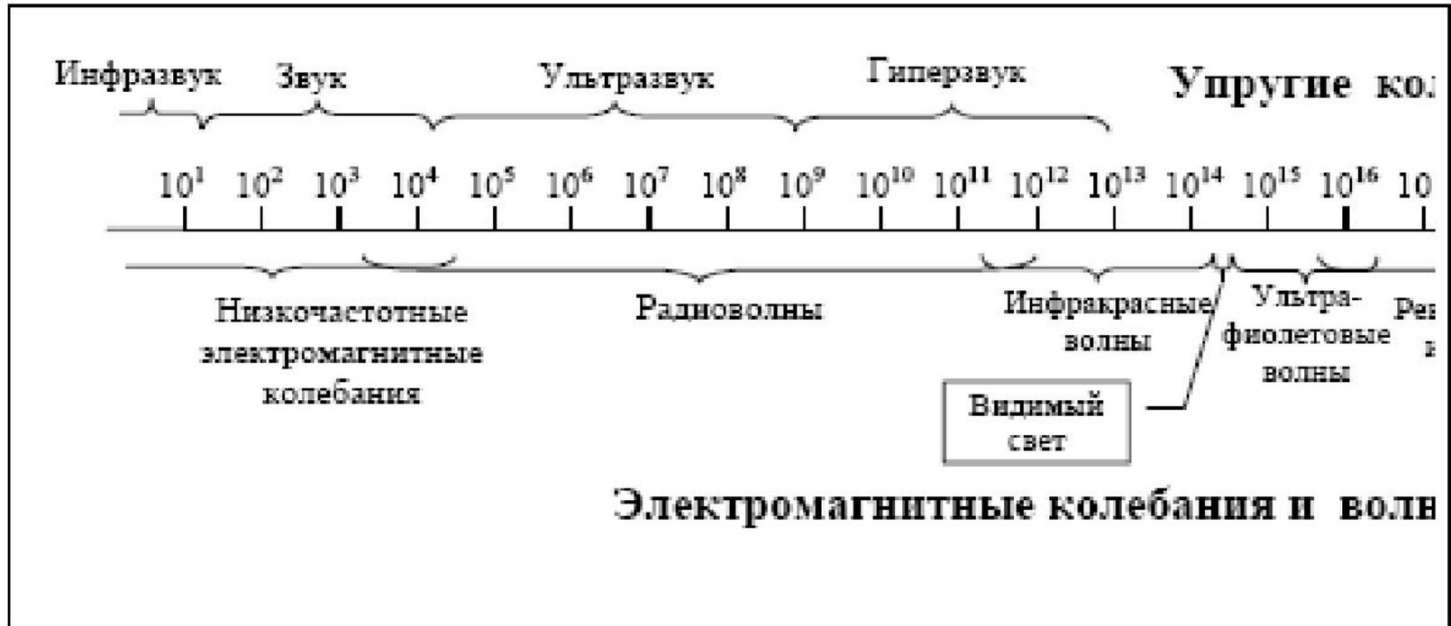
Распределение упругих и электромагнитных волн по частоте
