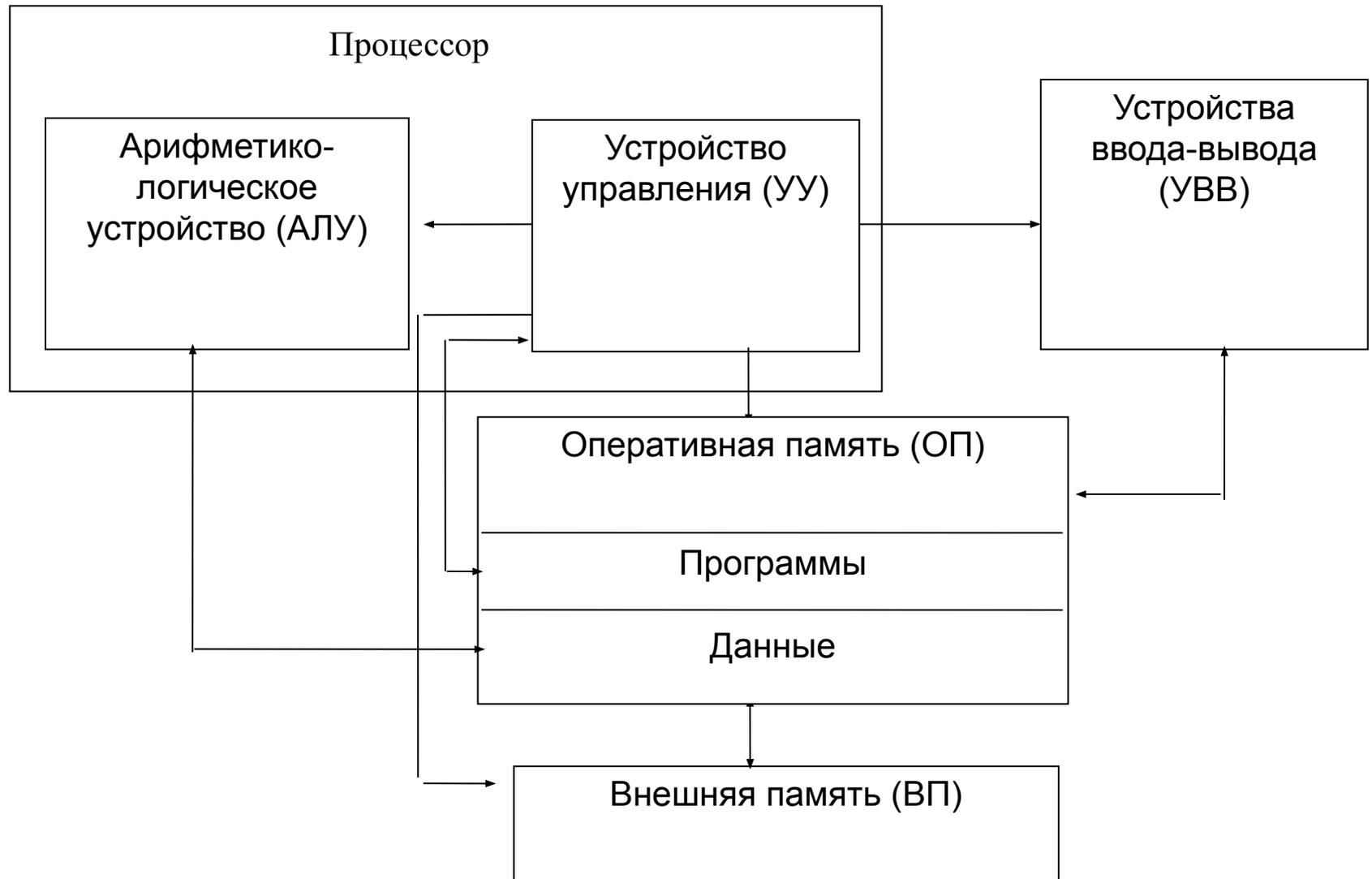
На схеме представлены: *память* (оперативная и внешняя), состоящая из перенумерованных ячеек (*номер ячейки* называют *адресом*); *процессор*, включающий в себя *устройство управления* (УУ) и *арифметико-логическое устройство* (АЛУ); *устройство ввода*; *устройство вывода*. Эти устройства соединены каналами связи, по которым передается информация (управляющая – прерывистые стрелки, данные – непрерывные стрелки).
