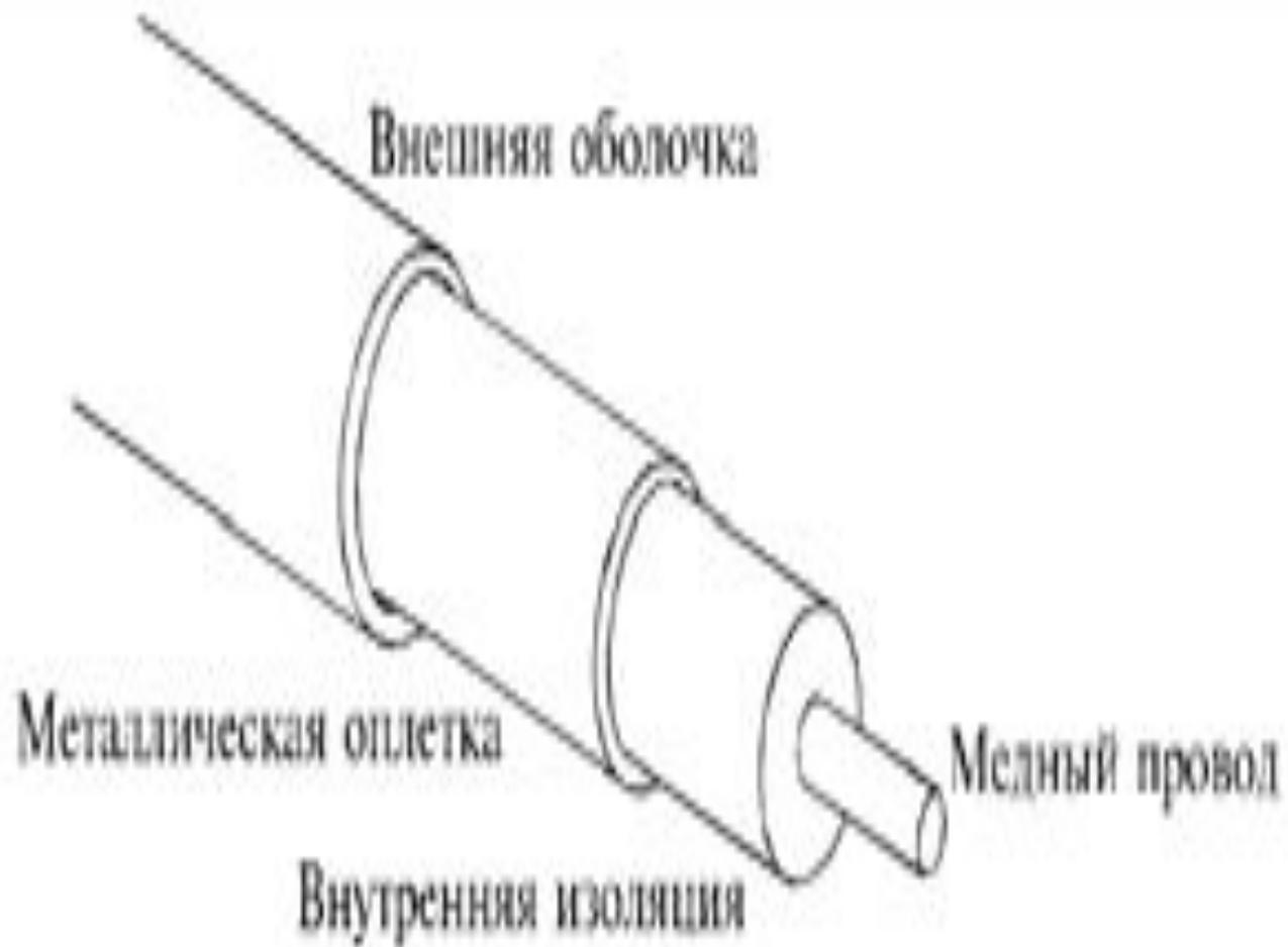
*Коаксиальный кабель* представляет собой электрический кабель, состоящий из центрального медного провода и металлической оплетки (экрана), разделенных между собой слоем диэлектрика (внутренней изоляции) и помещенных в общую внешнюю оболочку.
