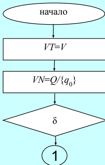
множество  $VN$  грамматики  $G$  строится на основании множества  $Q$  автомата  $M$  так, чтобы каждому состоянию автомата, за исключением начального состояния, соответствовал один нетерминальный символ грамматики
