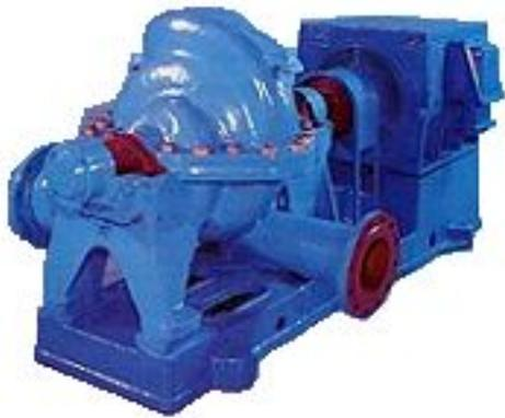
Насосы ЦН–900-310, ЦН–1000-180 горизонтальные спиральные, с рабочим колесом одностороннего входа. Предназначены для перекачки чистой воды и других жидкостей, сходных с водой по вязкости и химической активности, температурой до  $100^{\circ}\text{C}$ , содержащих твердые включения не более 0.005% по массе размером до 0,2 мм.
