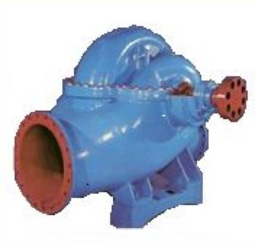
Насосы типа "Д" – горизонтальные насосы с колесами двустороннего всасывания с полуспиральным подводом жидкости к рабочему колесу. Предназначены для перекачивания воды и других жидкостей, сходных с водой по вязкости и химической активности, содержащие твердые включения размером до 0,2 мм, объемная концентрация которых не превышает 0,05%
