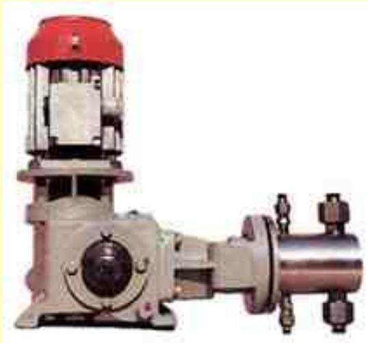
Насос типа НД – агрегат дозировочный одноплунжерный, предназначен для объемного напорного дозирования нейтральных и агрессивных жидкостей, эмульсий и суспензий с температурой до  $100^{\circ}\text{C}$ , с максимальной плотностью  $2000 \text{ кг/м}^3$ , с концентрацией твердой неабразивной фазы не более 1% от диаметра условного прохода соединительных патрубков. Регулирование подачи производится вручную, путем изменения длины хода плунжера при остановленном агрегате.
