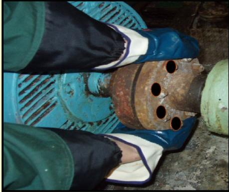
До сочленения электродвигателя и насоса провернуть ротор насоса вручную и убедиться в отсутствии его заклинивания
