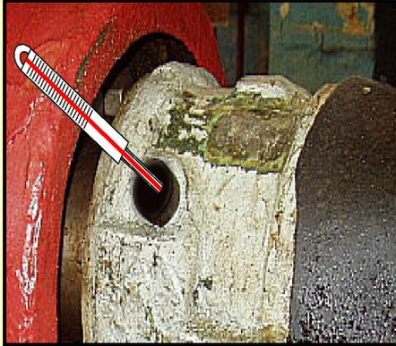
Проверить температуру подшипников, она не должна превышать температуру, указанную в паспорте насоса.
