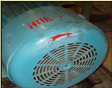
Вызвать электротехнический персонал для сборки электрической схемы и пробным пуском электродвигателя проверить правильность вращения электродвигателя, оно должно совпадать со стрелками, имеющимися на электродвигателе и корпусе насоса.
