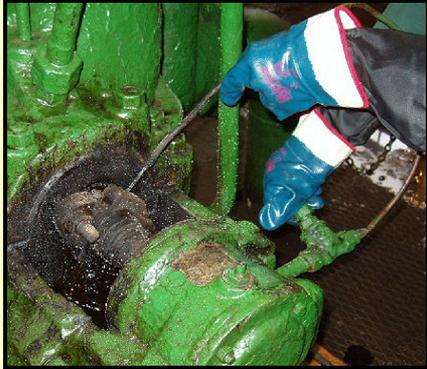
Подать воду на охлаждение подшипников и сальниковых уплотнений (при наличии водяного охлаждения)
