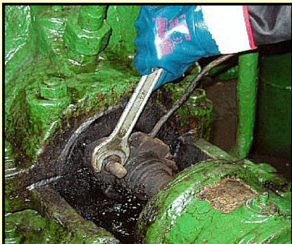
Предварительно отрегулировать сальниковые уплотнения вала насоса так, чтобы они пропускали не более 60 капель в минуту.
