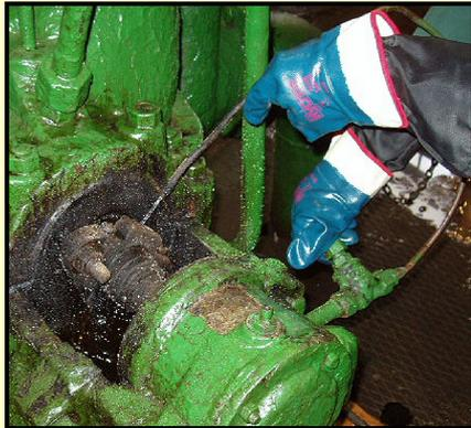
Перекрыть вентили на трубопроводах, подводящих воду на охлаждение сальников и подшипников (при наличии водяного охлаждения)
