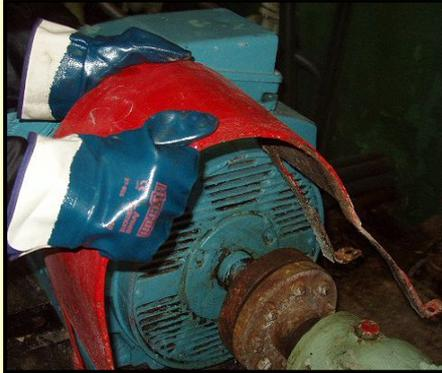
Снять защитное ограждение полумуфт
