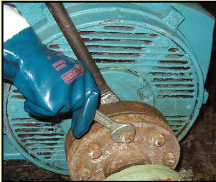
Снять крепление (пальцы), соединяющие полумуфты электродвигателя и насоса.
