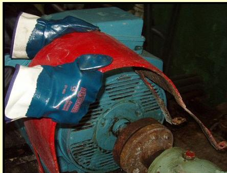
Установить защитное ограждение на вращающиеся части насосного агрегата. Ограждение должно быть выполнено или изнутри обшито искробезопасным материалом.
