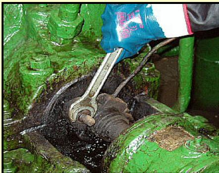
Проверить состояние сальниковых уплотнений, в случае их нагрева – остановить насос и увеличить протекание через них жидкости путем ослабления нажимной втулки сальникового уплотнения, после чего опять пустить насосный агрегат.
