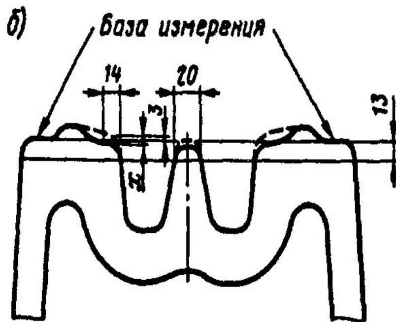
Измерение вертикального износа  $x$  усовиков сборной (а) и цельнолитой (б) острых крестовин
