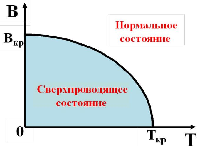
В 1933 году немецкие физики В.Мейсснер и Р. Оксенфельд обнаружили, что магнитное поле практически не проникает внутрь сверхпроводника (глубина проникновения магнитного поля чрезвычайно мала и составляет  $\sim 10^{-8}$  м).
