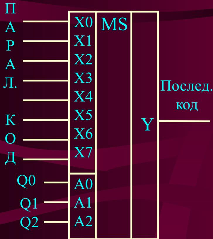
Операцию преобразования параллельного кода в последовательный (сдвиг кода) можно реализовать на логических комбинационных схемах, например, на мультиплексорах.
