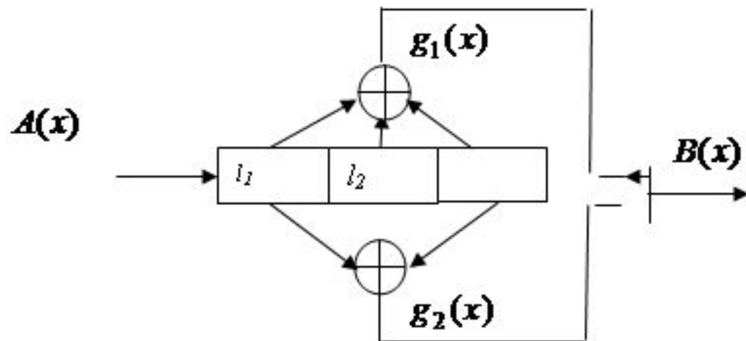
Рис. 9,6. Кодировующее устройство
