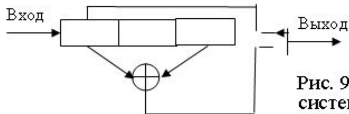
Рис. 9.2. Примеры кодеров систематического (а) и несистематического (б) сверточного кода
