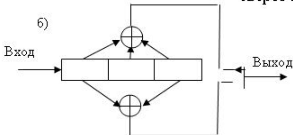
Для того чтобы задать структуру сверточного кодера, необходимо указать, какие ячейки регистра сдвига связаны с каждым из сумматоров, счет разрядов ведется слева направо. Связи  $j$ -го сумматора описываются путем задания  $j$ -й порождающей последовательности
