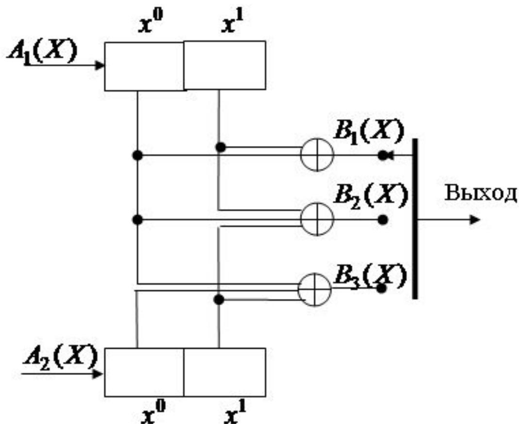
Рис. 9.4. Пример кодера со скоростью 2/3
