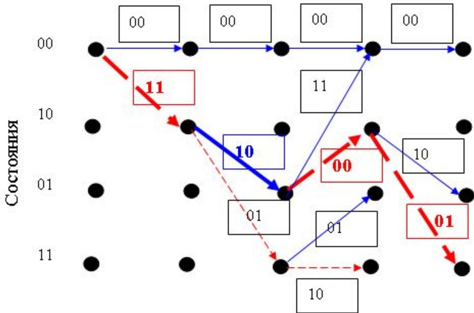
Рис.9.9. Кодирование последовательности 1011
