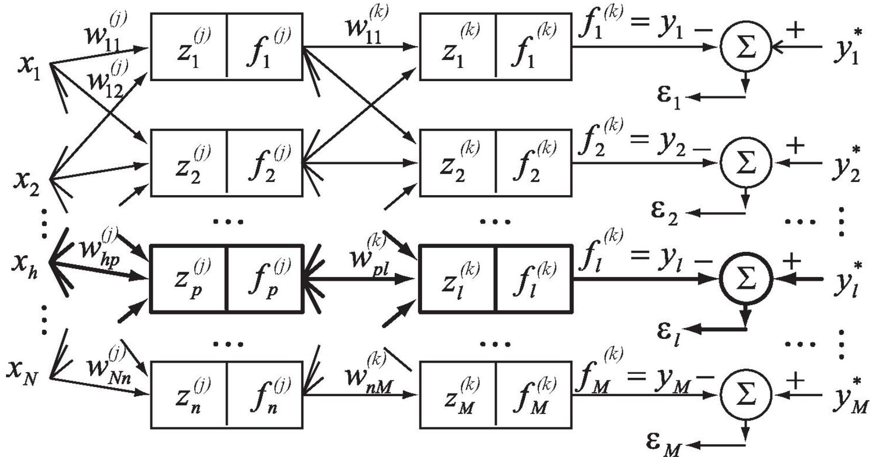
Рис.3.25 – Фрагмент сети прямого распространения
