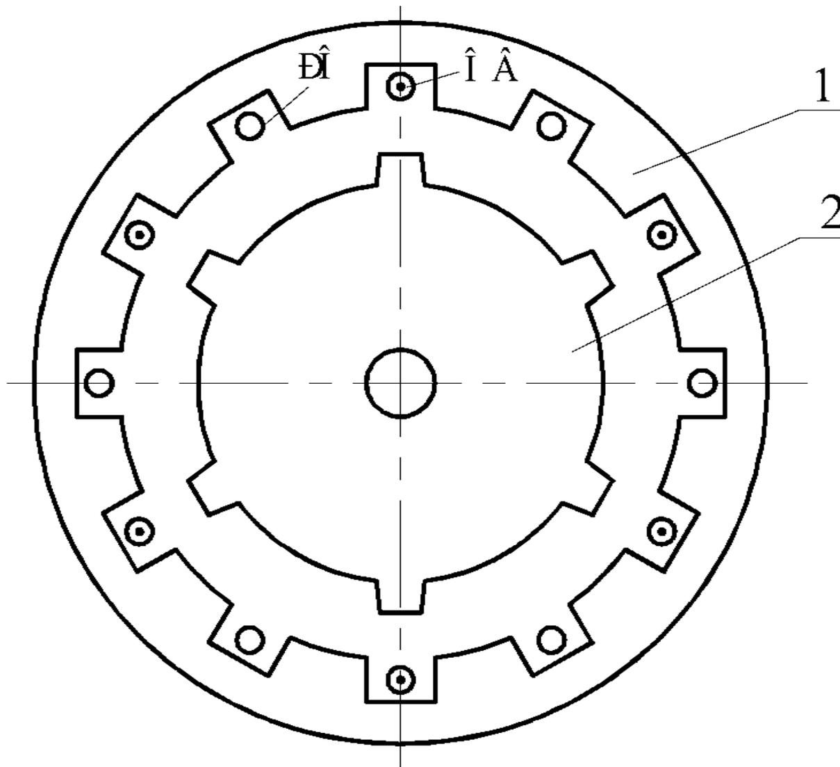
Схематический вид индукторного генератора:
