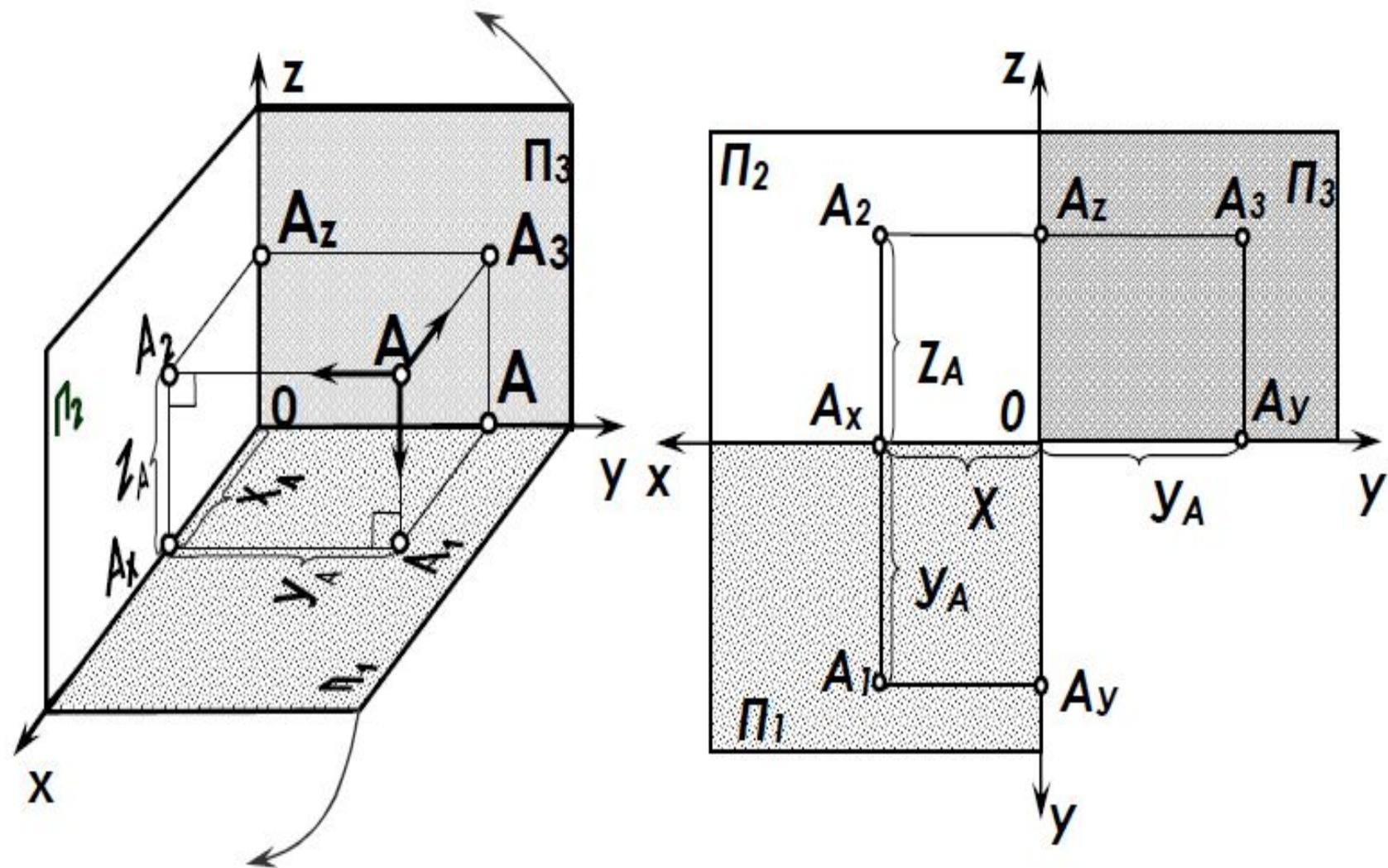
1. На наглядном и комплексном чертежах построить профильную проекцию  $A_3$  точки  $A$ . Написать названия элементов чертежей в таблице.
