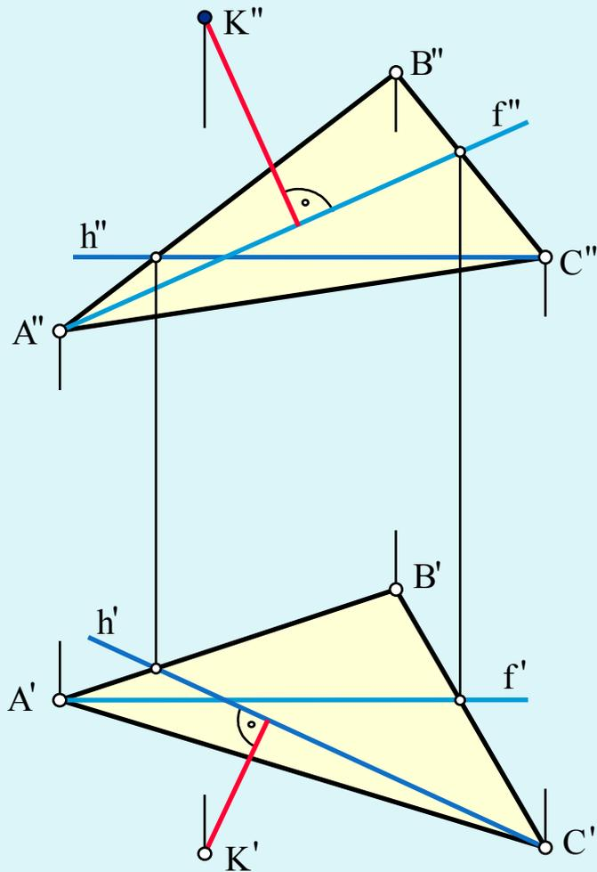
На плоскости проводят горизонталь  $h$  ( $h''$ ,  $h'$ ) и фронталь  $f$  ( $f'$ ,  $f''$ ).
