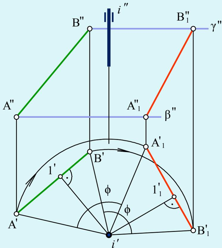
Фронтальные проекции  $A''_1$  и  $B''_1$  точек  $A$  и  $B$  перемещаются по прямым, перпендикулярным линиям связи, которые являются фронтальными проекциями плоскостей вращения  $\gamma$  и  $\beta$ . При вращении вокруг горизонтально проецирующей оси треугольник  $A'i'B'$  конгруэнтен треугольнику  $A'_1i'B'_1$ , следовательно конгруэнтны их высоты  $i'C'$  и  $i'C'_1$ .
