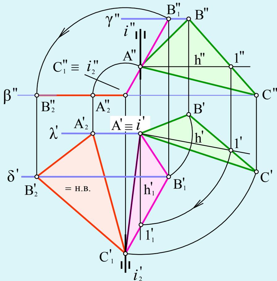
Можно сделать вывод, что при вращении плоской фигуры вокруг проецирующей оси, проекция ее на плоскость, к которой ось вращения перпендикулярна, не изменяется по величине, так как не изменяется наклон плоской фигуры к этой плоскости проекций, а меняется только положение этой проекции относительно линий связи. Вторая же проекция на плоскости, параллельной оси вращения, изменяется и по форме и по величине.
