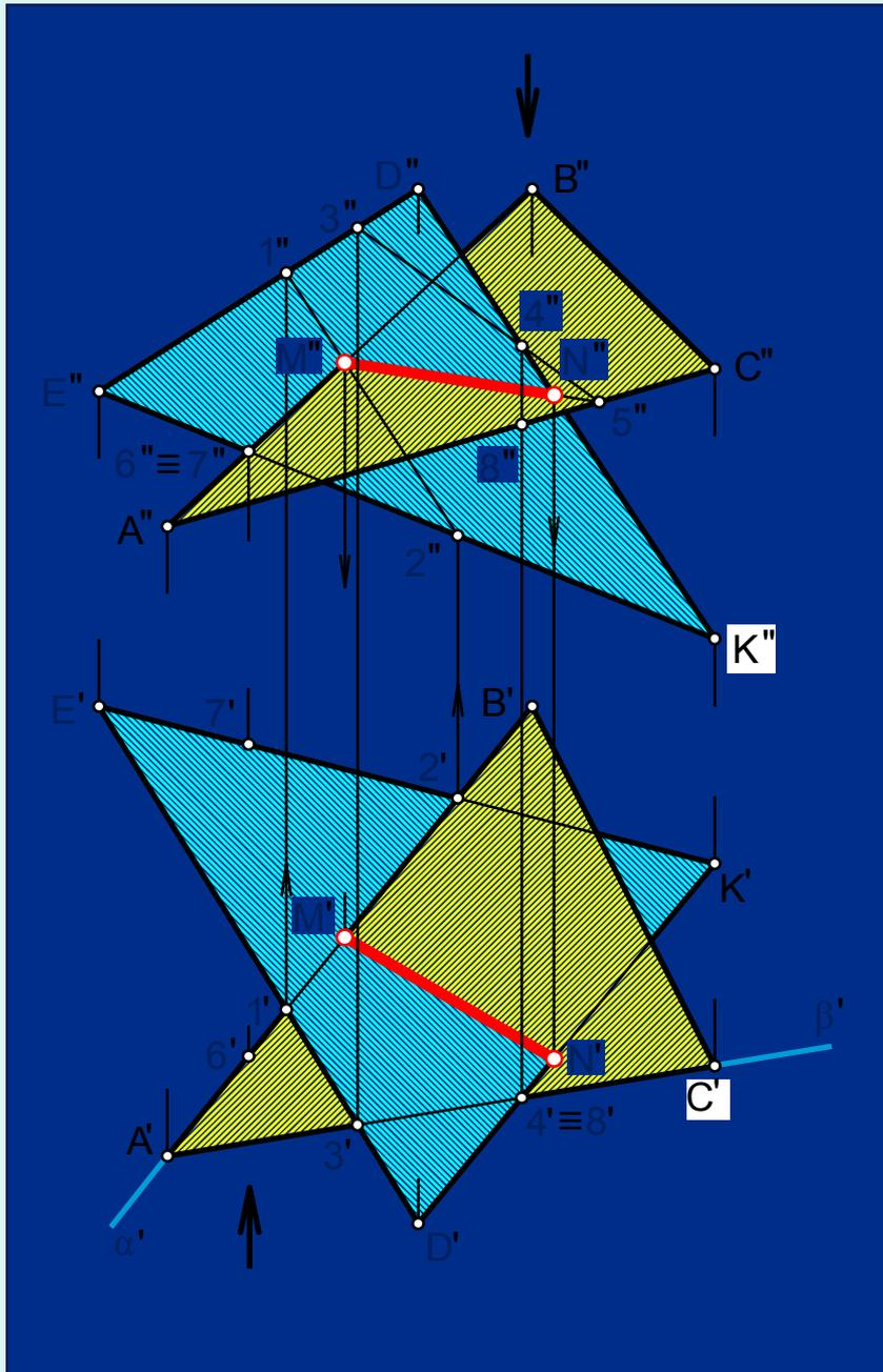
Определение видимости на плоскости **H** выполнено с помощью горизонтально конкурирующих точек **4** и **8** ( $4' \equiv 8'$ ).
