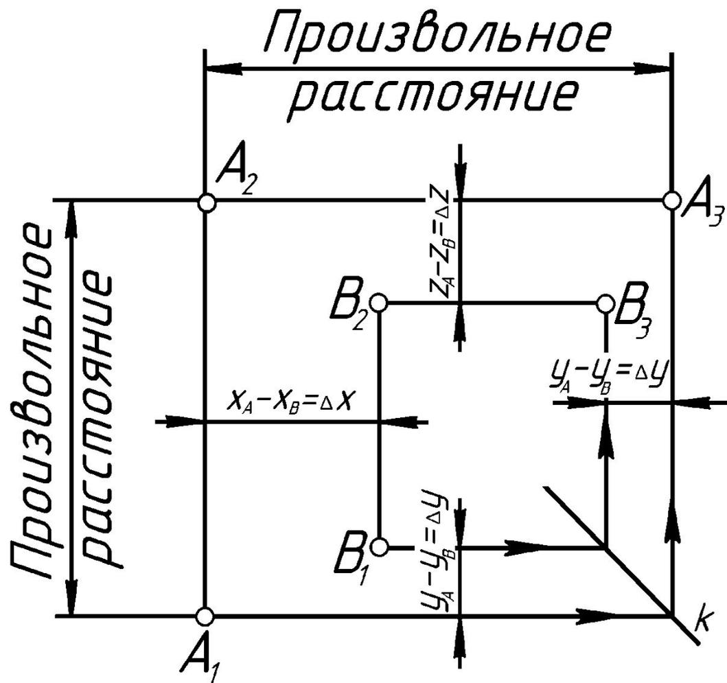
**Задача . Построить три проекции отрезка  $AB$  по заданной разности координат:  $\Delta x = X_A - X_B = 30$ ;  $\Delta y = Y_A - Y_B = 20$ ;  $\Delta z = Z_A - Z_B = 25$  (проекции одной из точек, например,  $A$  взять произвольно).**
