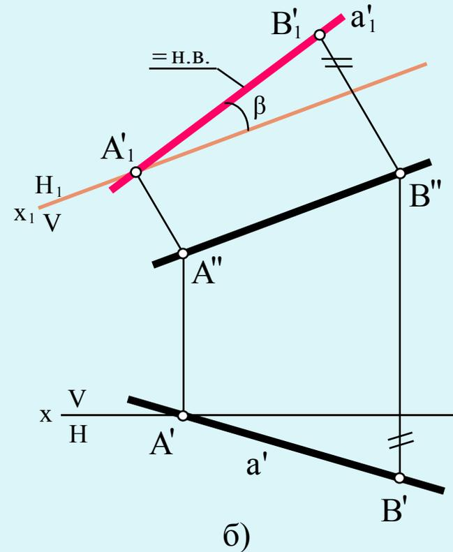
На плоском чертеже новая ось  $x_1$  проведена параллельно  $a'$ , новые линии связи  $A'A_1''$  и  $B'B_1''$  проведены перпендикулярно оси  $x_1$ . Новые фронтальные проекции  $A_1''$  и  $B_1''$  точек  $A$  и  $B$  получают, измерив от оси  $x$  на поле  $V$  координаты высот  $z_A$  и  $z_B$ , отложив их от оси  $x_1$  на новое поле  $V_1$ . Новая проекция  $a_1''$  дает натуральную величину отрезка  $AB$  и угол  $\alpha$  наклона его к плоскости  $H$ .
