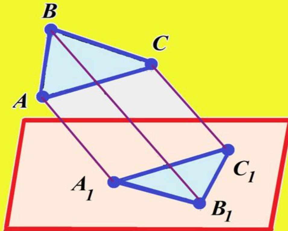
Если центр проекций удален в бесконечность, то все проецирующие лучи становятся параллельными и проецирование называется параллельным. В этом случае задается направление проецирования **S**.
