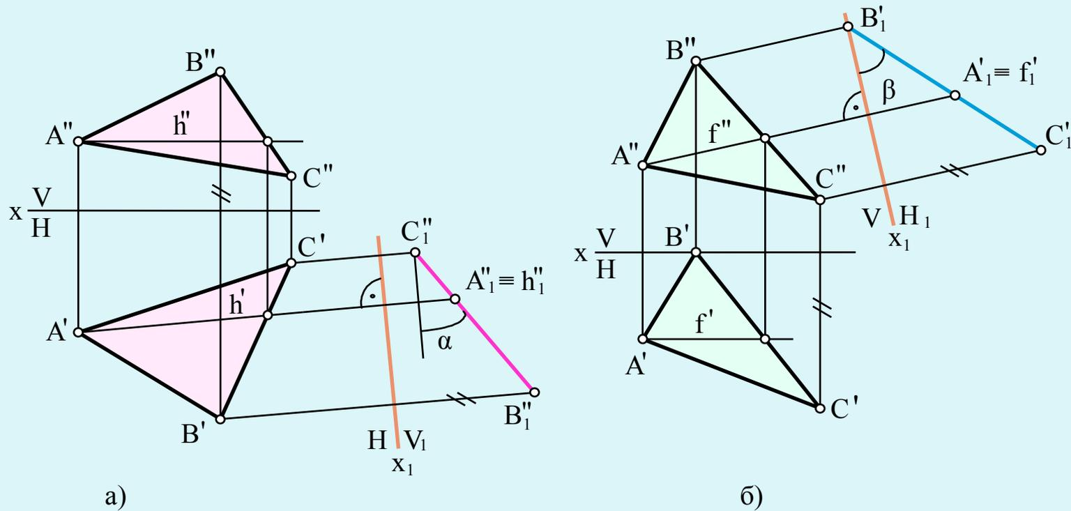
Для этого в плоскости  $ABC$  проведена горизонталь  $h$ . Новая плоскость проекций  $V_1$  расположена перпендикулярно  $H$ . Горизонталь на поле  $V_1$  изобразится точкой, а вся плоскость прямой линией  $C_1''A_1''B_1''$  с углом  $\alpha$ , который определяет угол наклона плоскости  $ABC$  к плоскости  $H$  (рис.а).
