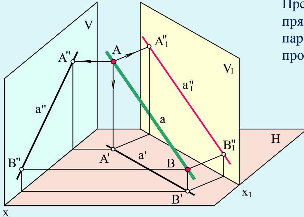
Новую проекцию прямой, отвечающую поставленной задаче, можно построить на новой плоскости проекций  $V_1$ , расположив ее параллельно самой прямой и перпендикулярно плоскости  $H$ , т.е. от системы плоскостей  $V/H$  с осью проекций  $x$  следует перейти к системе  $H/V_1$  с новой осью  $x_1$ .
