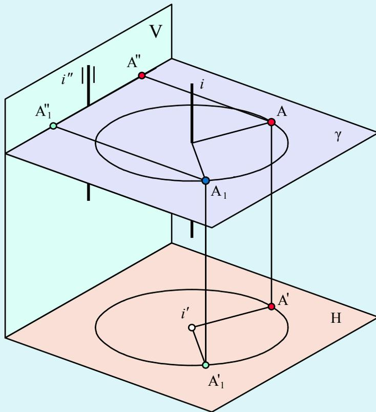
Точка **A**, вращаясь вокруг горизонтально проецирующей оси **i**, опишет окружность, плоскость которой **γ** перпендикулярна **i** и параллельна **H**. На плоскость **H** эта окружность проецируется без искажения, а на плоскость **V** - в виде отрезка прямой, параллельной оси **x**. Центр окружности расположен в точке пересечения оси вращения **i** с плоскостью **γ**, а величина радиуса определится как расстояние от точки **A** до оси **i**.
