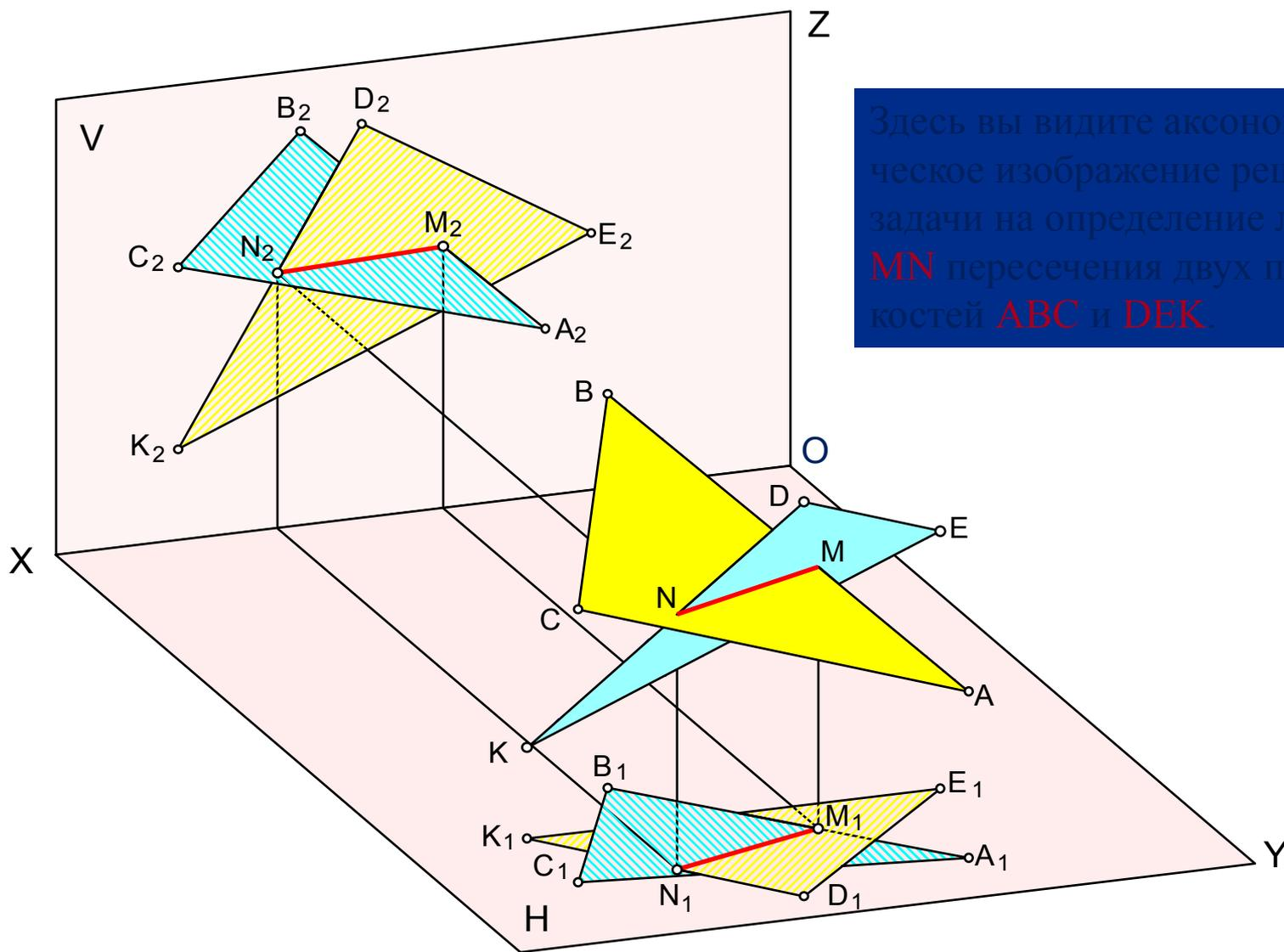
Здесь вы видите аксонометрическое изображение решения задачи на определение линии  $MN$  пересечения двух плоскостей  $ABC$  и  $DEK$ .
