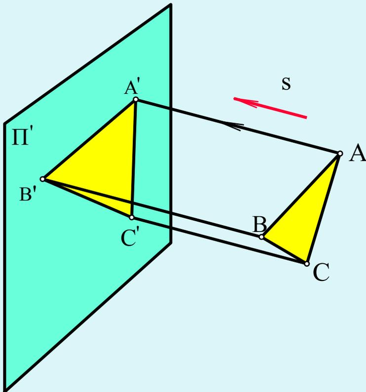
Ортогональная проекция получила наибольшее распространение в технических чертежах. Чертежи, полученные рассмотренными методами проецирования, не обладают свойством обратимости, т.е. по данному чертежу воспроизвести оригинал не решается однозначно
