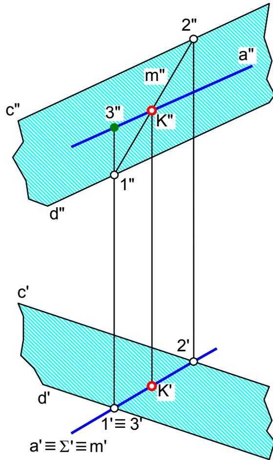
Задачу заканчивают определением видимости прямой по правилу конкурирующих точек. Так, на плоскости  $H$  видимость определена с помощью горизонтально конкурирующих точек  $1$  и  $3(1' \equiv 3')$ , где точка  $1$  принадлежит плоскости  $\alpha$  а точка  $3$  - прямой  $a$ . Точка  $3$  расположена над точкой  $1$ , поэтому точка  $3$  и прямая  $a$  в этом участке на плоскости  $H$  будет видима.
