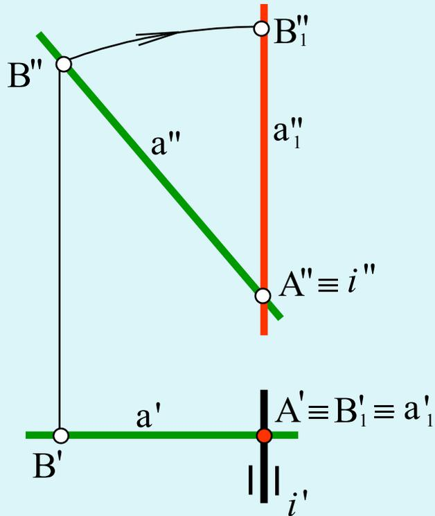
На рисинке прямая **a** задана фронталью, т.е. параллельной плоскости **V**, поэтому за ось вращения необходимо взять фронтально проецирующую прямую **i**, проходящую через точку **A**. Вращается точка **B** прямой **a**. Ее фронтальная проекция **B''** описывает дугу окружности, а горизонтальная **B'** перемещается по прямой.
