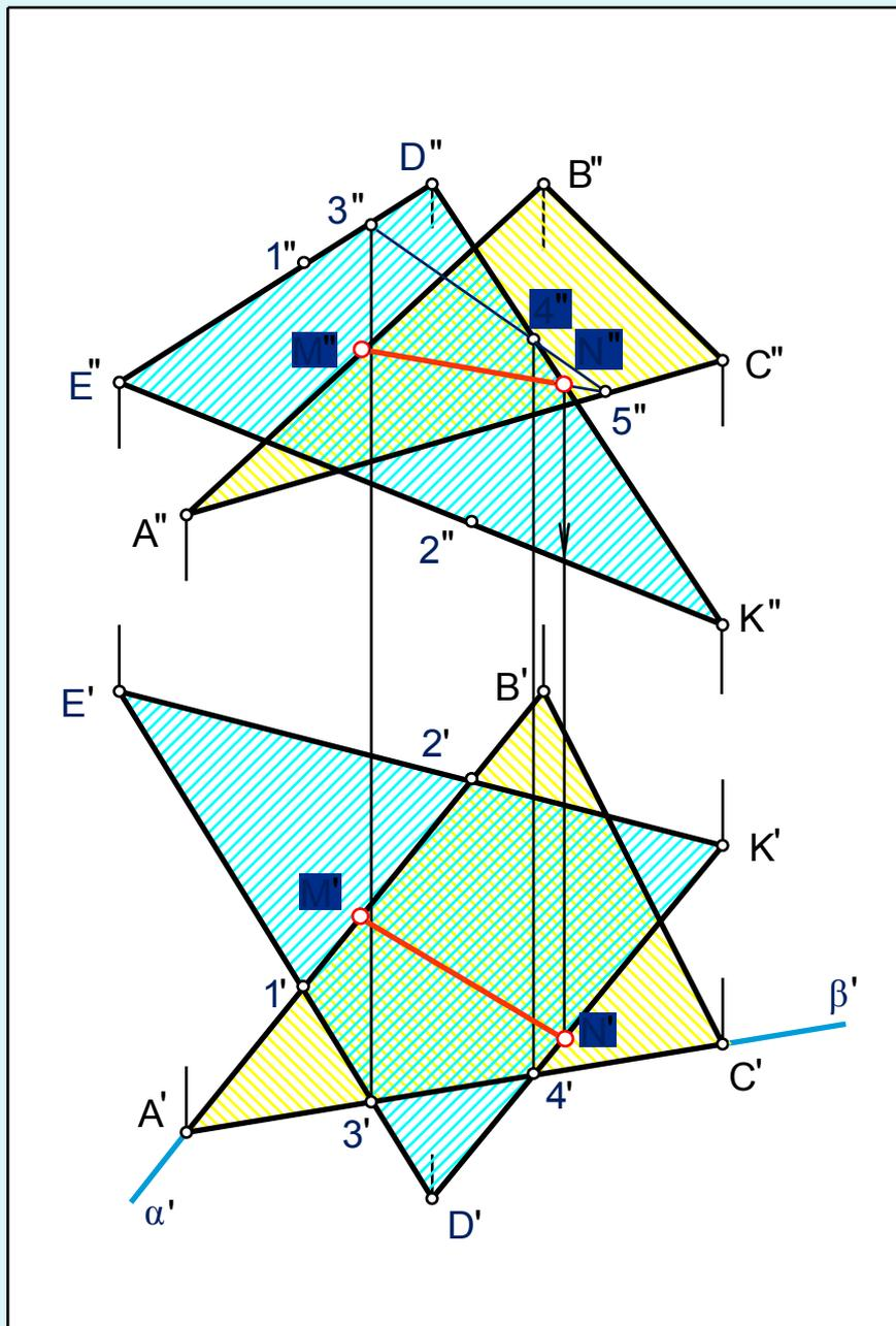
Для построения точки **N** использована горизонтально проецирующая плоскость  $\beta$  ( $\beta''$ ), в которую заключена сторона **AC** треугольника **ABC**.
