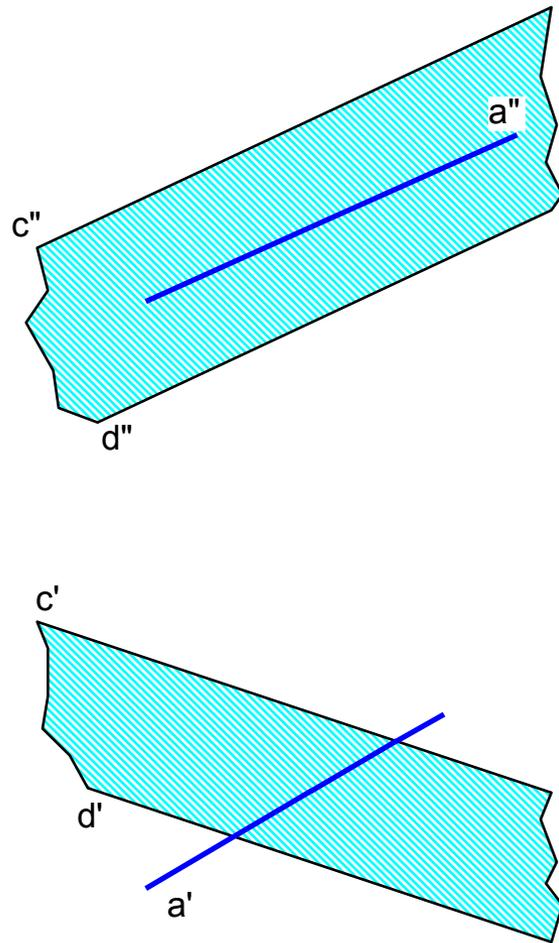
В третьем, общем, случае построение искомой точки  $K$  пересечения прямой  $a$  с плоскостью  $\alpha$  ( $c//d$ ) выполнено по описанному алгоритму.
