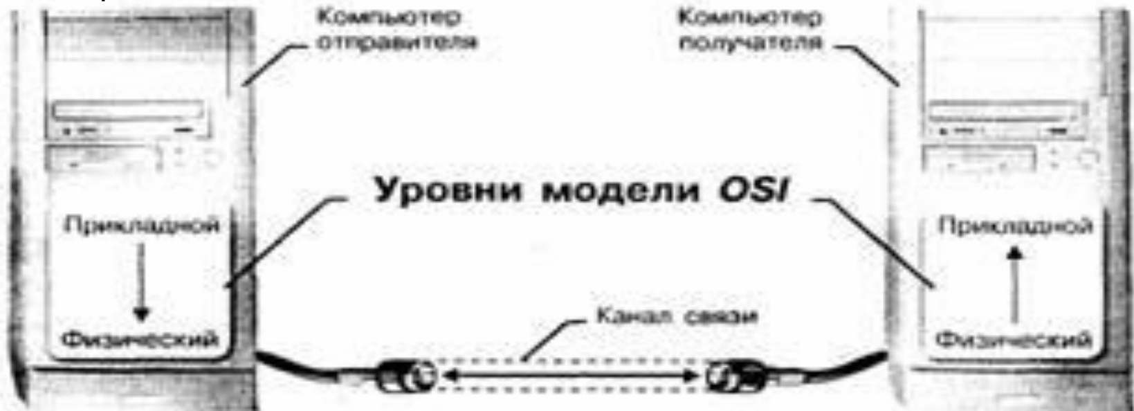
Рис. 8.1. Простейшая модель обмена данными в компьютерной сети
